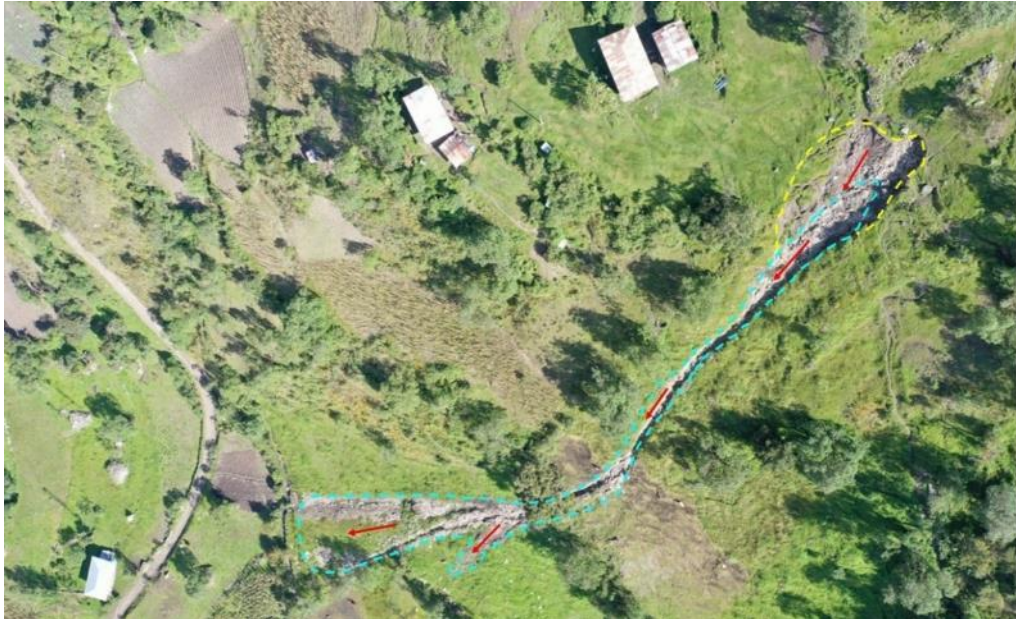
Figura 27. Derrumbe (línea discontinua amarilla) convertido en flujo de detritos (línea discontinua celeste) al este del derrumbe principal.
