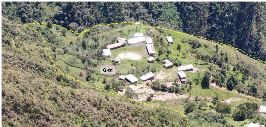
Figura 7. Depósito coluvio-deluvial antiguo sobre el cual se ha asentado la comunidad de La Chamana.
