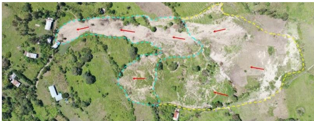
Figura 32. Vista cenital del movimiento complejo de San Juan de Tacabamba, mostrando la zona de deslizamiento (línea discontinua amarilla) y de flujo (línea discontinua celeste).
