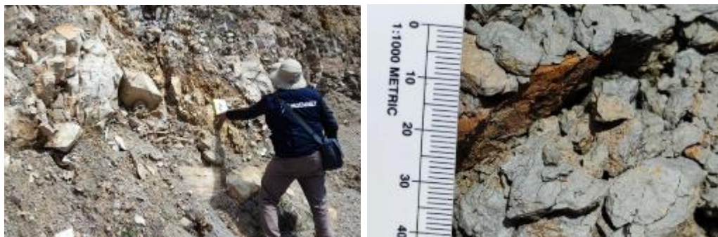
Fotografía 2. Detalle de un macizo de la formación Inca: a la izquierda se aprecia el alto fracturamiento y plegamiento del macizo rocoso y a la derecha un acercamiento a los estratos de lutitas de esta unidad.
