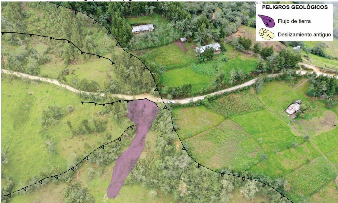
**Figura 20.** Vista aérea del flujo 2, ubicado en un deslizamiento antiguo con procesos de reactivación.
