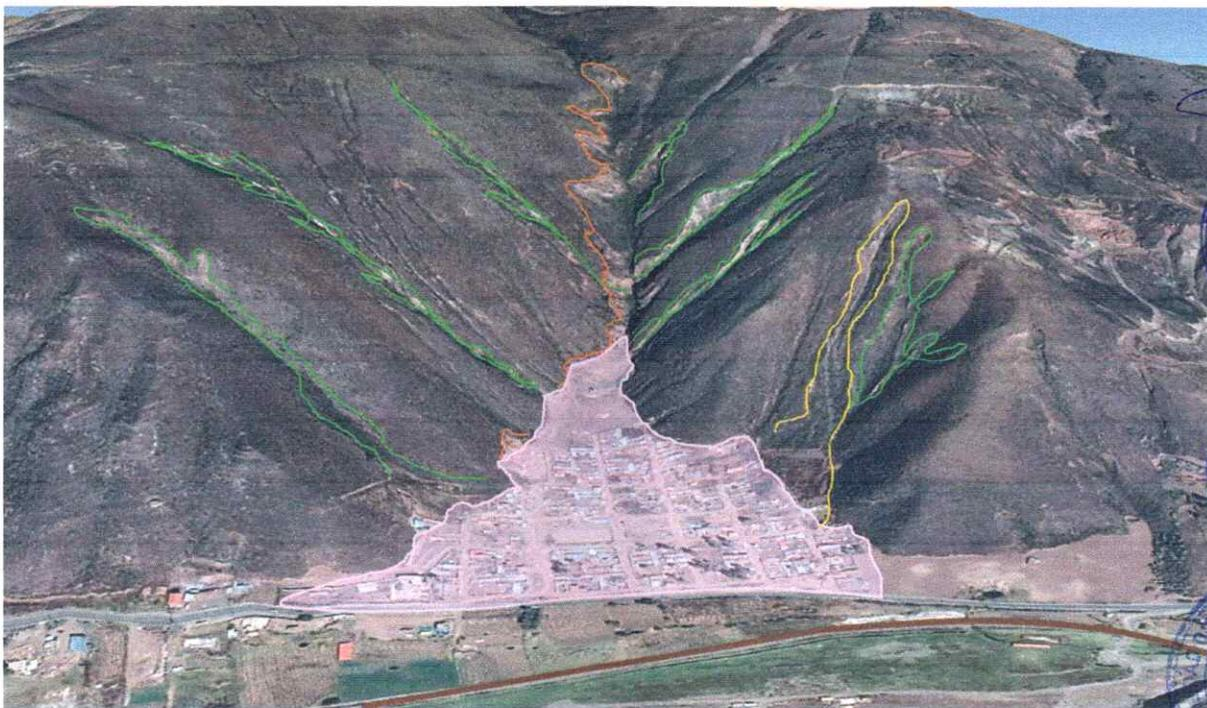
Figura 4. Imagen Google Earth de setiembre del 2021, vista de la APV Vilcanota (Villa Hermosa de Quechasiyoc), es posible observar zonas de deslizamientos (amarillo), flujo de detritos activo (rosado), erosión de cárcavas (verde), erosión de cárcavas (naranja), población asentada sobre el material del flujo de detritos). En la parte baje se observa también la línea férrea (marrón).
