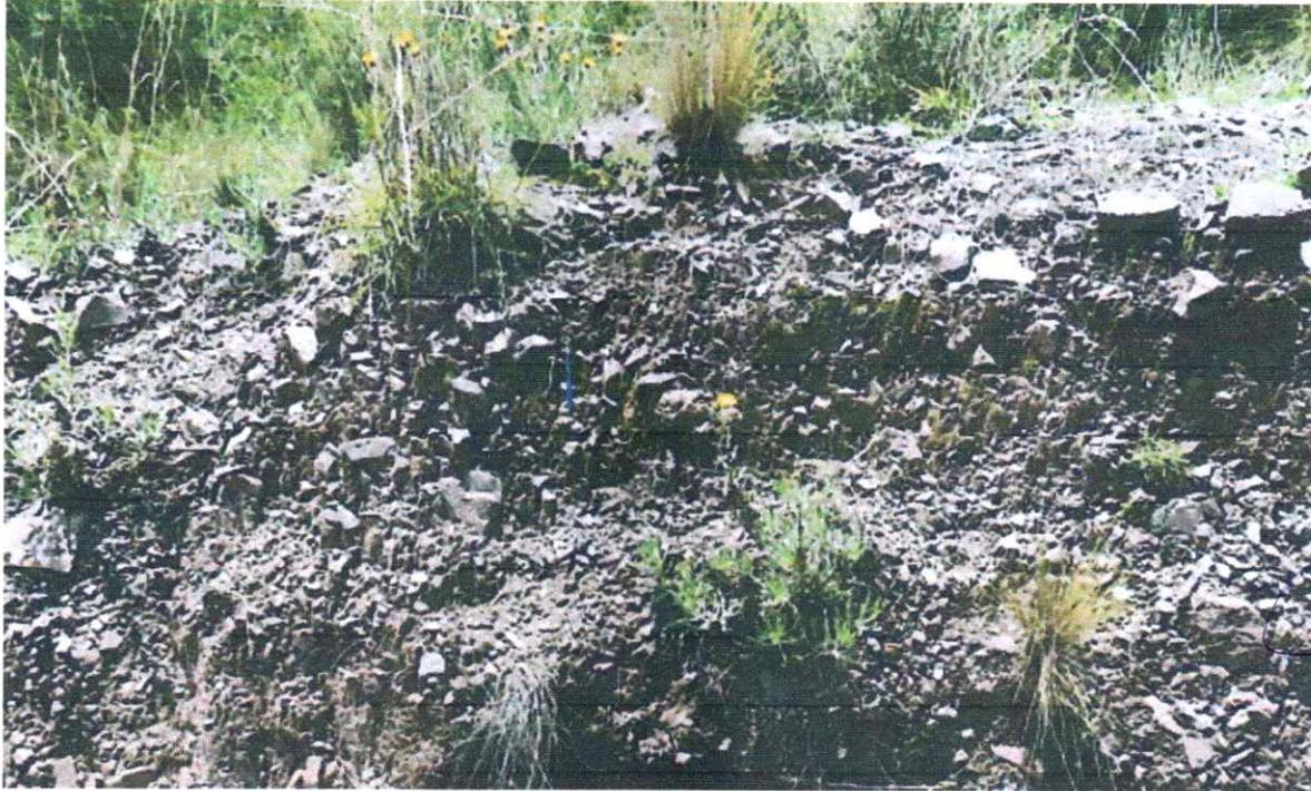
Fotografía 6. Depósito coluvial tomado en la Quebrada Sacrayochuayco, conformado por clastos angulosos y matriz arenoso.
