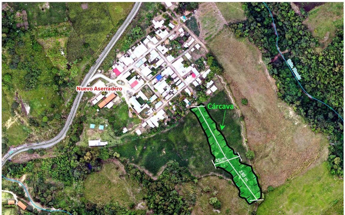
**Figura 13.** La cárcava con dirección al área urbana tiene un largo de 230m y un ancho de 45m.
