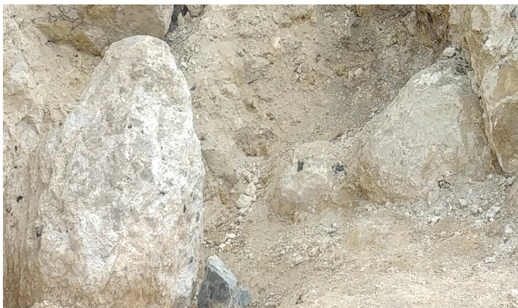
Fotografía 7. Calizas margosas poco fracturadas, moderadamente meteorizadas. Coordenadas UTM WGS84, Norte: 9301995 – Este: 755160.
