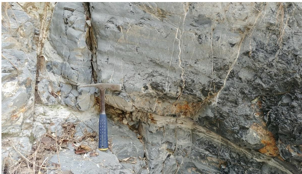
Fotografía 6. Afloramiento rocoso, poco fractuado y ligeramente meteorizado. Coordenadas UTM WGS84, Norte: 9301511 – Este: 755150.
