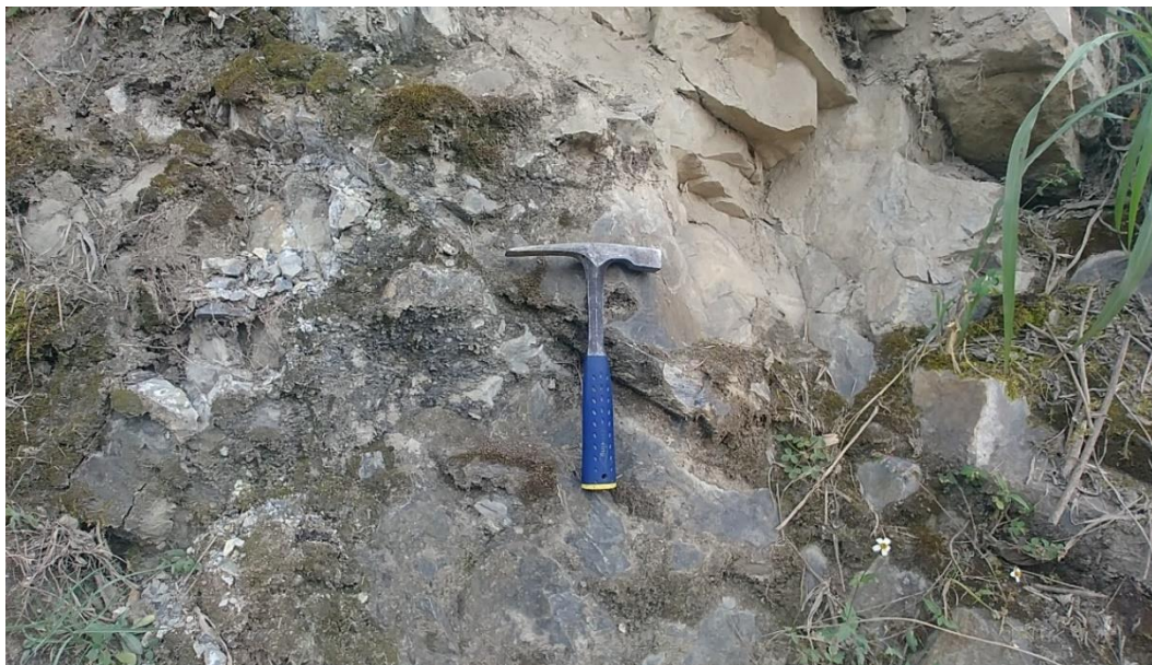
Fotografía 4. Afloramiento rocoso, fractuadas y ligeramante meteorizadas. Coordenadas UTM WGS84, Norte: 9301923 – Este: 754056.
