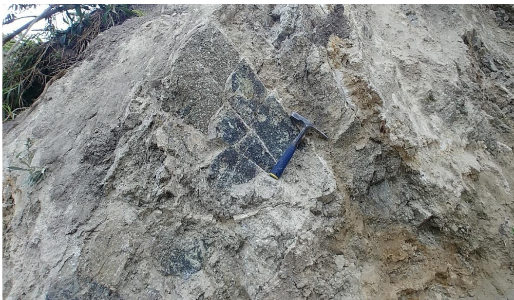
Fotografía 3. Afloramiento rocoso, intrusivo diorítico, poco fractuado y altamente meteorizado. Coordenadas UTM WGS84, Norte: 9300785 – Este: 754066
