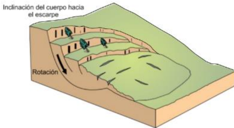
Imagen 4.- Esquema de un Deslizamiento Rotacional
