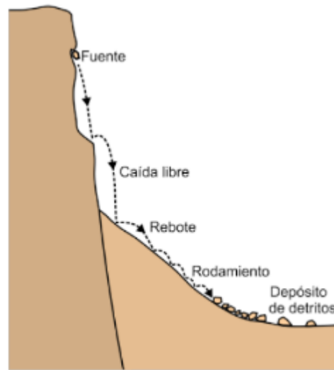
Imagen 1.- Esquema de caída de rocas
