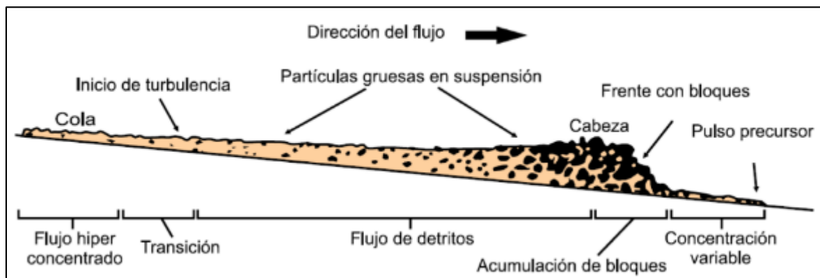
Imagen 5.- Esquema de un Flujo de Detritos
