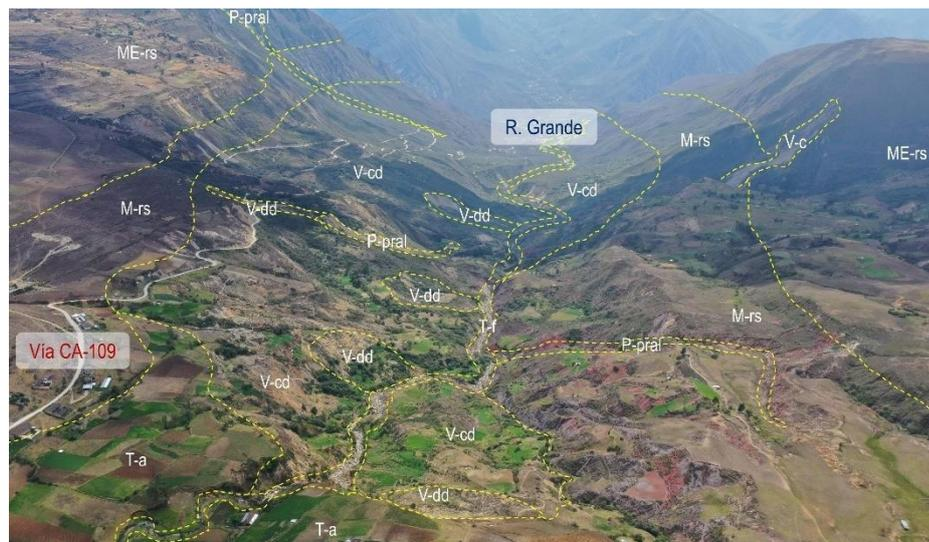
**Figura 15.** Vista de las geoformas del valle del río Grande: Montaña estructural en rocas sedimentarias (ME-rs), montaña en rocas sedimentarias (M-rs), vertiente coluvio-deluvial (V-cd), vertiente coluvial (V-c), vertiente con depósito de deslizamiento (V-dd), piedemonte proluvial o aluvio-torrencial (P-pral), terraza aluvial (T-a) y terraza fluvial (T-fl)
