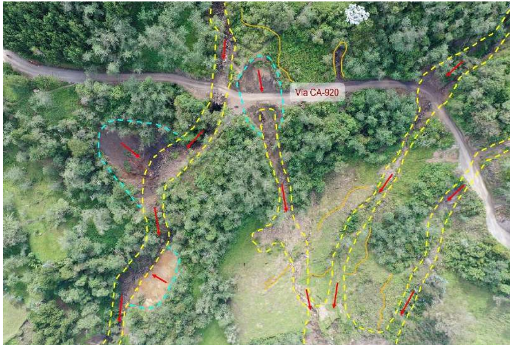
Figura 12. Vista de derrumbes (línea discontinua celeste), flujos de detritos (línea discontinua amarilla) y agrietamientos (línea anaranjada) cartografiados al noroeste de la zona que afectan a la vía y terrenos de las comunidades. Ubicación referencial - Este: 769977; Norte: 9294470.
