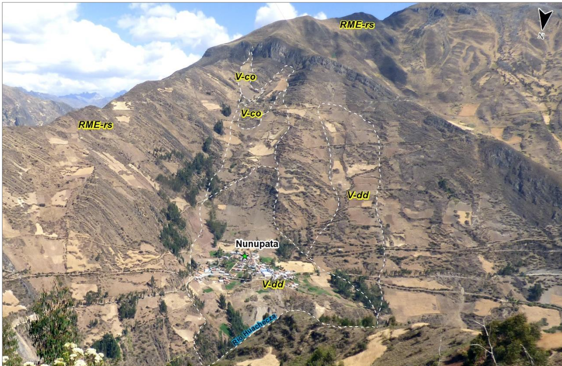
Figura 5. Unidades geomorfológicas. RME-rs: Montaña estructural modelada en roca sedimentaria. V-cd: Vertiente coluvio - deluvial. V-dd: Vertiente con depósito de deslizamiento.
