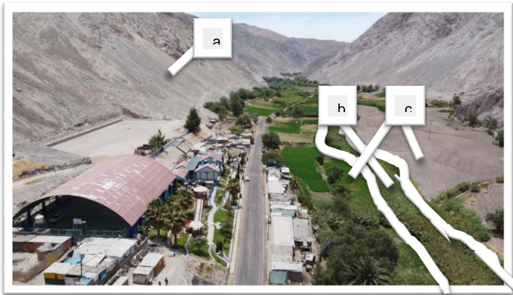
Gráfico N° 15. Medición de altura de sedimentación susceptible de ser acarreada en forma de flujos en periodos de lluvias extremas. Depósito deluvial entre 2.5 a 3 m de altura (a), altura de flujo en terrazas fluviales de 1 m (b), en el cauce del río Curibaya 2m (c).
