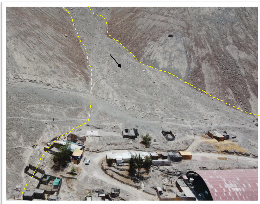
Gráfico N° 16. Medición de altura de sedimento del abanico aluvial donde se asienta el C.P. Chulibaya, con un espesor 8 m aproximadamente que llega hasta el límite de la terraza fluvio-aluvial. Cabe destacar que sobre este abanico discurren flujos menores de 0.50 m de espesor según rastro encontrado y relatos de los pobladores quienes indican que en el año 2019 descendió hasta la cancha de fútbol.
