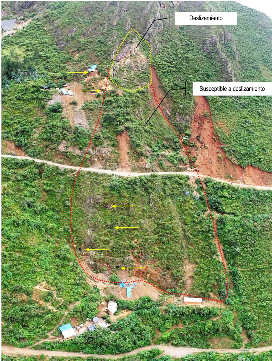
Figura 10. Las flechas señalan la actividad minera (socavones actuales y antiguos) en el talud inferior del deslizamiento. Coordenadas UTM: 213468.35 / 9138479.24, zona 18.
