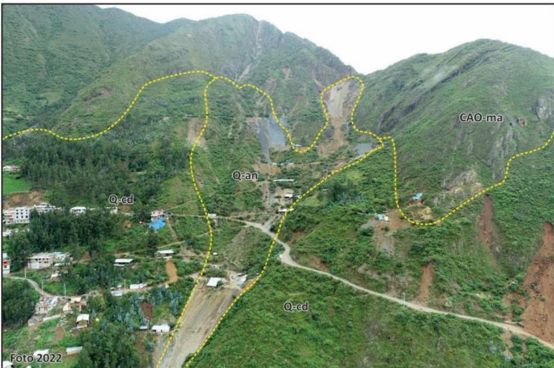
**Figura 3.** Macizo de la Formación Macno (CAO-ma) con cobertura de depósitos coluvideluviales (Q-cd); además, en la comparación de fotografías del 2009 y 2022 se observa el depósito antrópico (Q-an) acumulado por la actividad minera.
