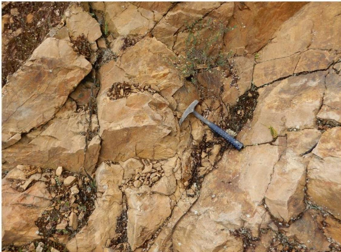
**Figura 2.** Valor GSI estimado para macizo conformado por intercalación de metareniscas y metapelitas con estructura fuertemente fracturada en bloques y espaciamentos próximas entre sí (0.15 – 0.30 m), abiertas (1.0 – 5.0 mm) y de resistencia media (50-100 Mpa).
