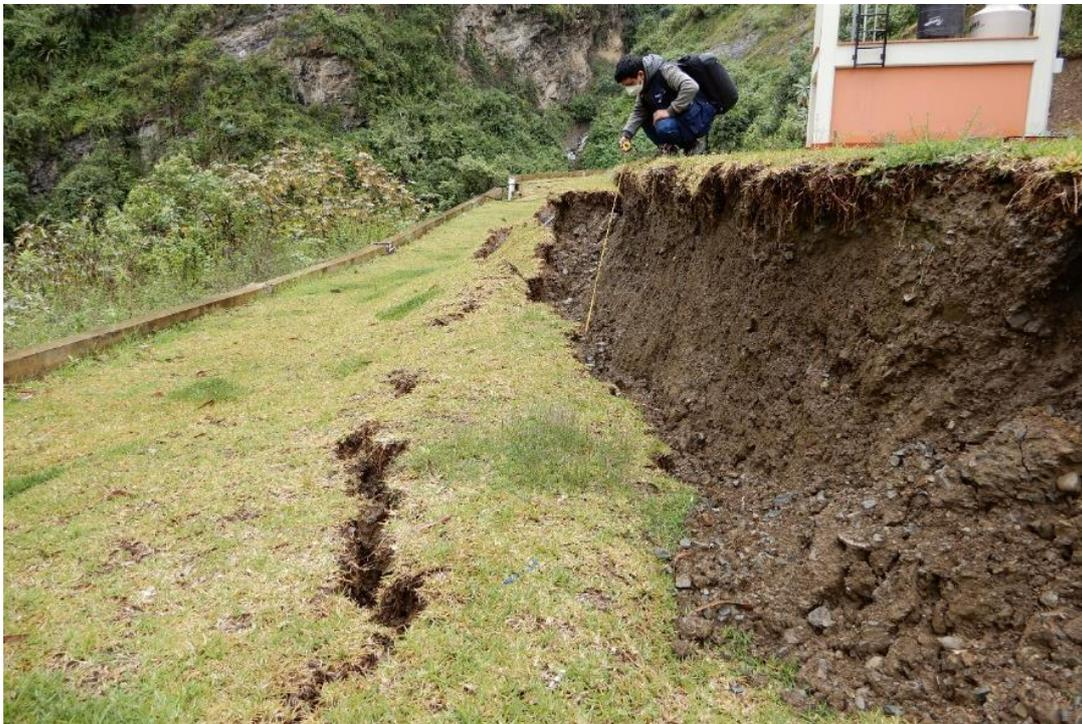
**Fotografía 12.** Escarpa principal del deslizamiento donde se observa el desplazamiento vertical. Coordenadas UTM: 214210.58 / 9138551.29, zona 18.
