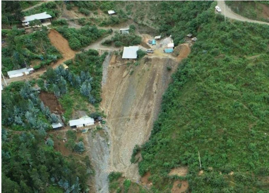
**Fotografía 6.** Acumulación de material de desmonte susceptible a la ocurrencia de flujos ubicado en la ladera superior de la localidad de Pataz.
