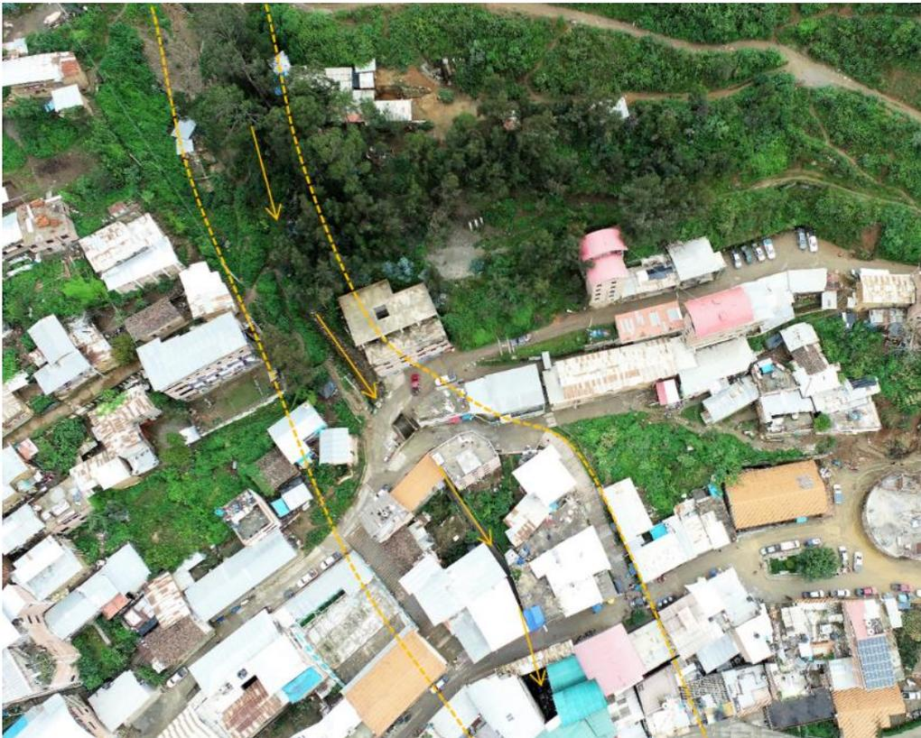
**Figura 8.** Trayecto tentativo del flujo de detritos que podría afectar la localidad de Pataz en caso de activación. Coordenadas UTM: 213777.66 / 9138528.19, zona 18.
