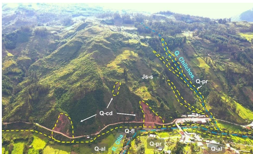
Figura 8. Formación Sarayaquillo (Js-s) y depósitos aluviales (Q-al), coluvio-deluviales (Q-cd), proluviales (Q-pr) y fluvial (Q-fl) en la parte alta de la quebrada Chilchos y las márgenes del río Olla.
