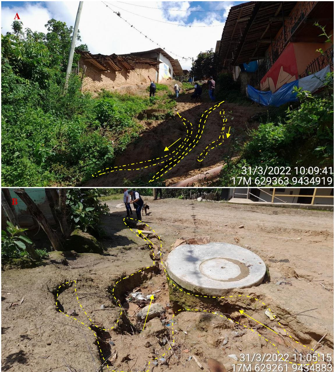
*Figura 4: Cárcavas (líneas amarillas) formadas en terrenos de pendiente mayor a los 15° de inclinación debido a los procesos erosivos generados por el desplazamiento del agua sobre los suelos. En la imagen A se aprecian cárcavas de la prolongación Av. Comercio y en la Imagen B se aprecian cárcavas contiguas a sistemas de alcantarillado en la Calle 06*
