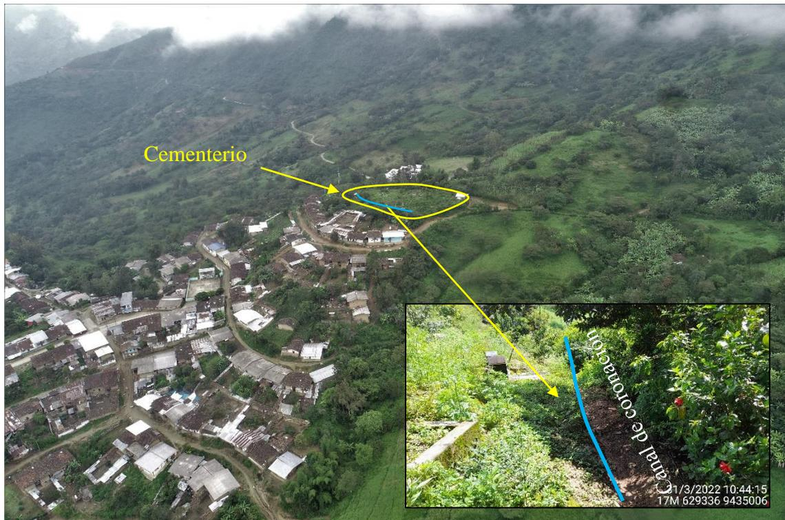
Figura 17.- Canales de coronación para evacuar las aguas de escorrentía del cementerio con la finalidad de evitar la infiltración del agua en las viviendas de la calle Palmeras
