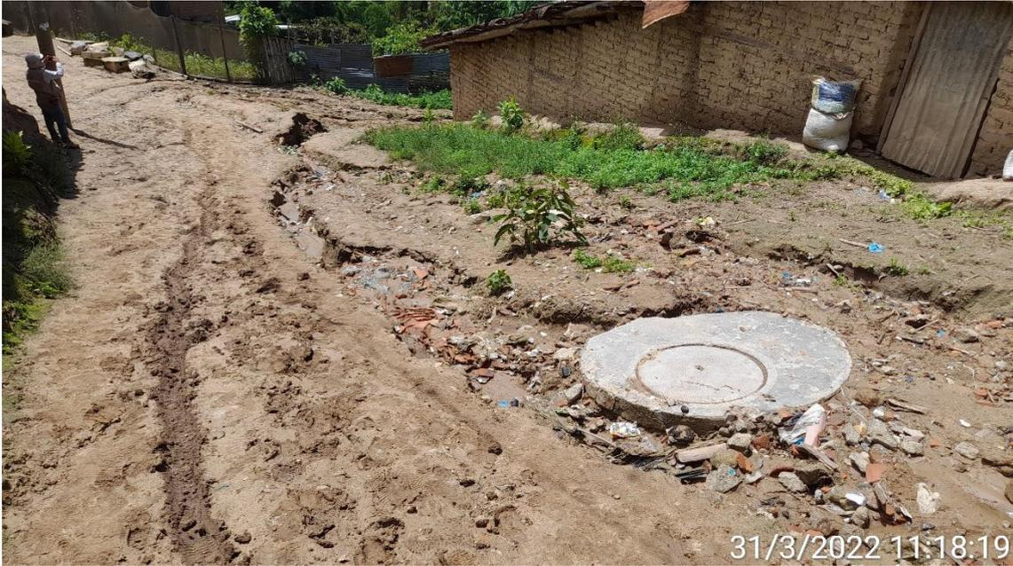
*Figura 11: Depósitos aluviales antiguos conformados por materiales heterogéneos (arenas mal graduadas con presencia de clastos subredondeados aislados) que constituyen los suelos del caserío Culebreros*
