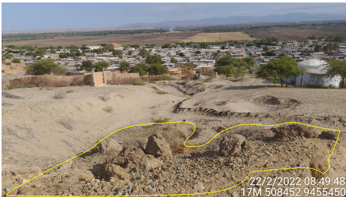
Figura 12: Materiales sueltos de naturaleza coluvial sobre la parte alta de la quebrada Seminario y que podrían mobilizarse pendiente abajo
