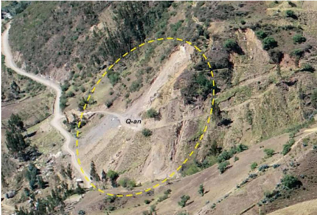
Figura 9. Vista en la margen izquierda del río, en la que se puede observar depósitos de relleno de construcción de trochas de carretera.
