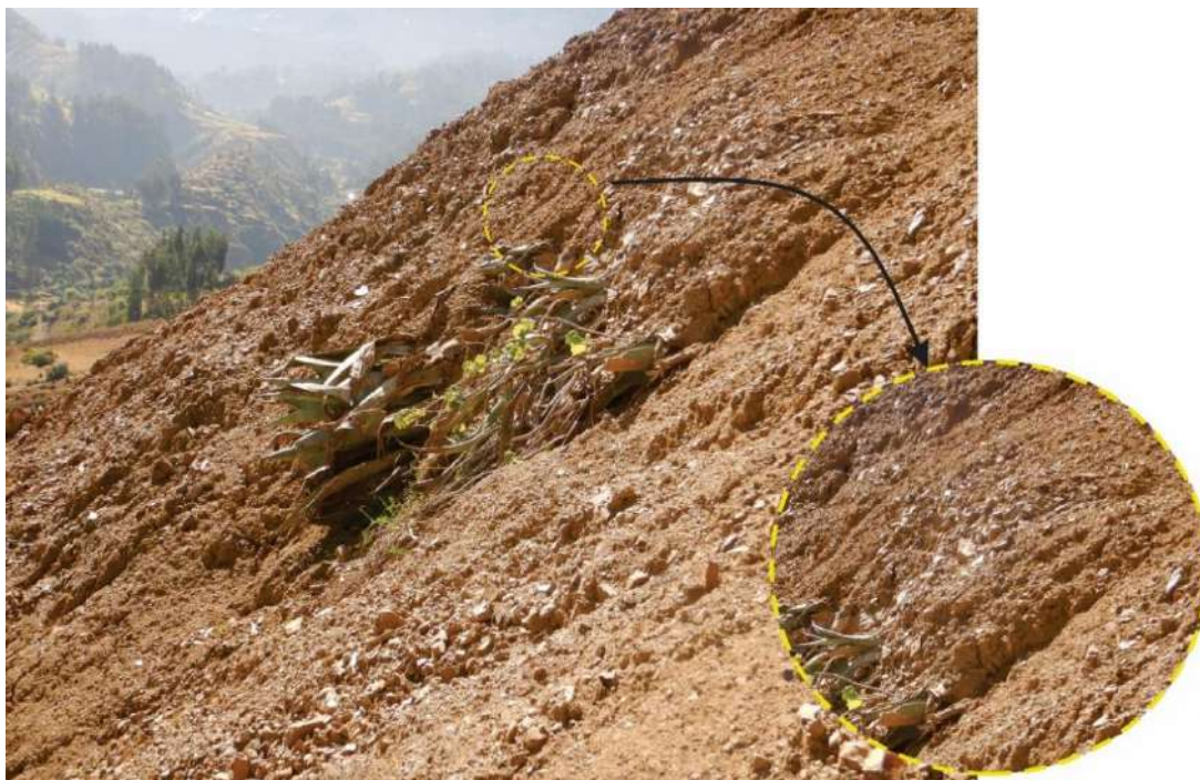
Figura 8. Vista del depósito coluvio-deluvial compuestos por fragmentos de roca angulosos a subangulosos de tamaños variables (0.03 a 0.09), envueltos en una matriz limo-arcillosos.
