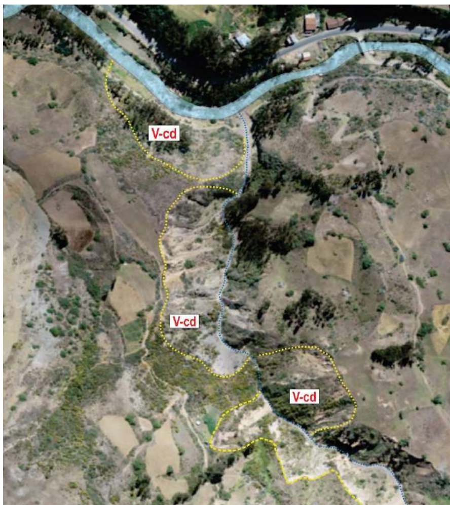
Figura 13. Vista tomada con el dron, donde se aprecia las subunidades de vertiente con depósito coluvio-deluvial (V-cd) ubicado en la margen derecha del cerro Cachipuquio, ubicado al pie de ladera de montañas sedimentarias.
