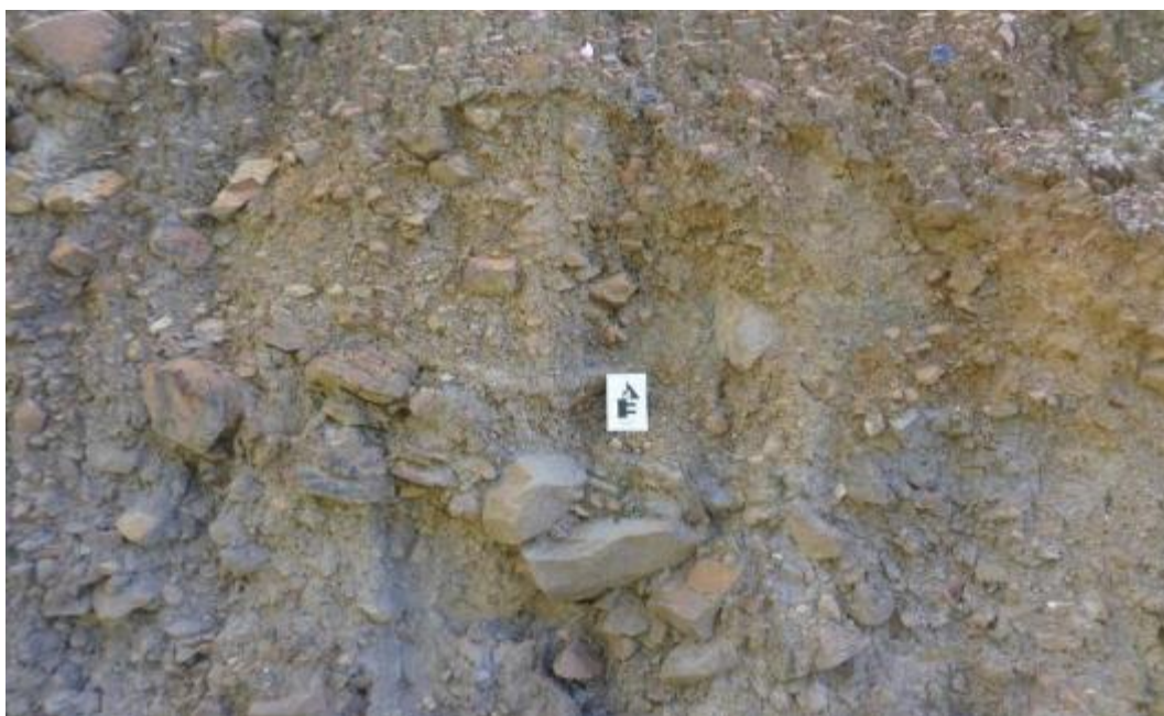
Fotografía 3. Vista del depósito coluvio-deluvial, donde se observa fragmentos de rocas de 1 cm a 40 cm envueltas en una matriz limo-arcilloso, ubicado con coordenadas UTM: 359550 E, 8856176 N.
