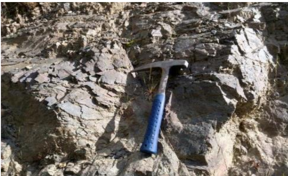
Fotografía 1. Afloramiento del Grupo Ambo, conformada por areniscas gris verdosas fracturadas, con coordenadas UTM (WGS 84): 359583.80 E; 8856138.78 N a 3411 m.s.n.m.
