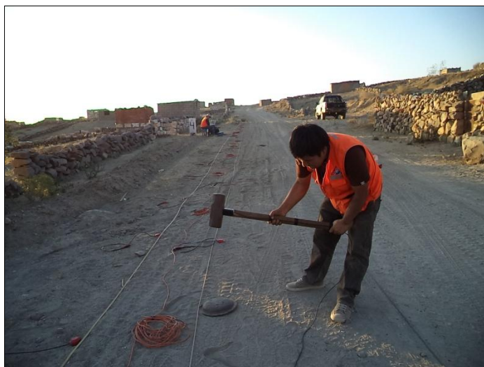
Figura 7.4. Ubicación del golpe con un martillo, para generar ondas durante ensayo MASW y refracción sísmica.
