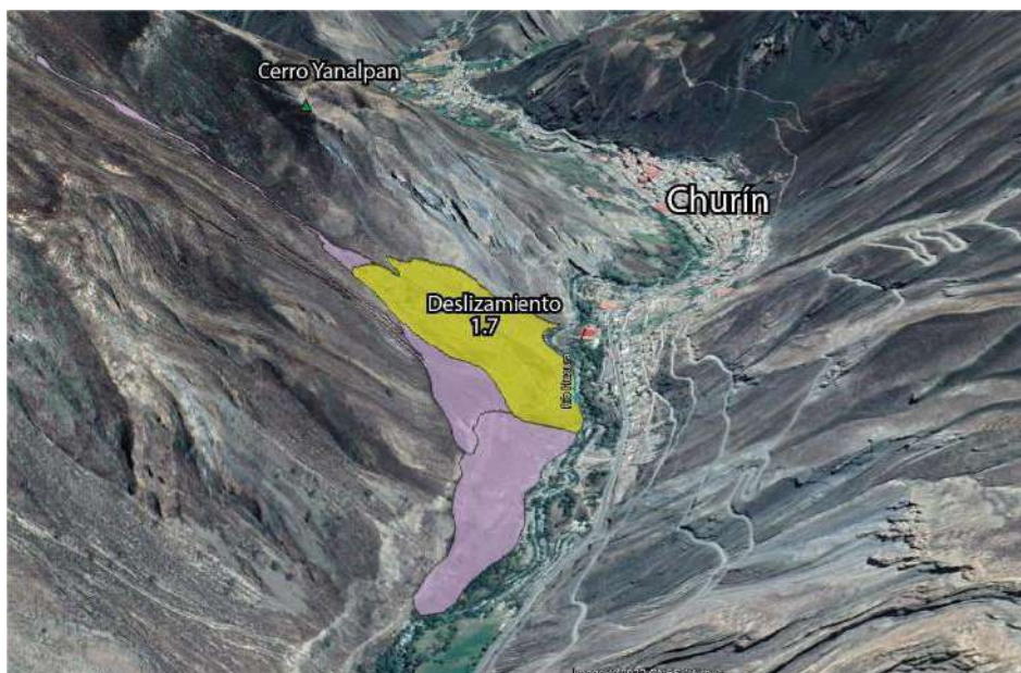
Figura 26. Evidencias de flujo de detritos descendientes de la quebrada ubicada al pie de la ladera sur del cerro Yanalpan, obsérvese el deslizamiento 1.7. descrito anteriormente en la margen derecha de la quebrada (vista lateral).
