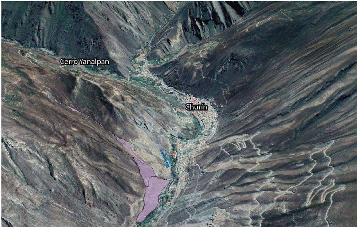
Figura 9. Depósitos proluviales (Qh-pl), en la margen derecha del río Huaura a 430 m aguas abajo de Churín.
