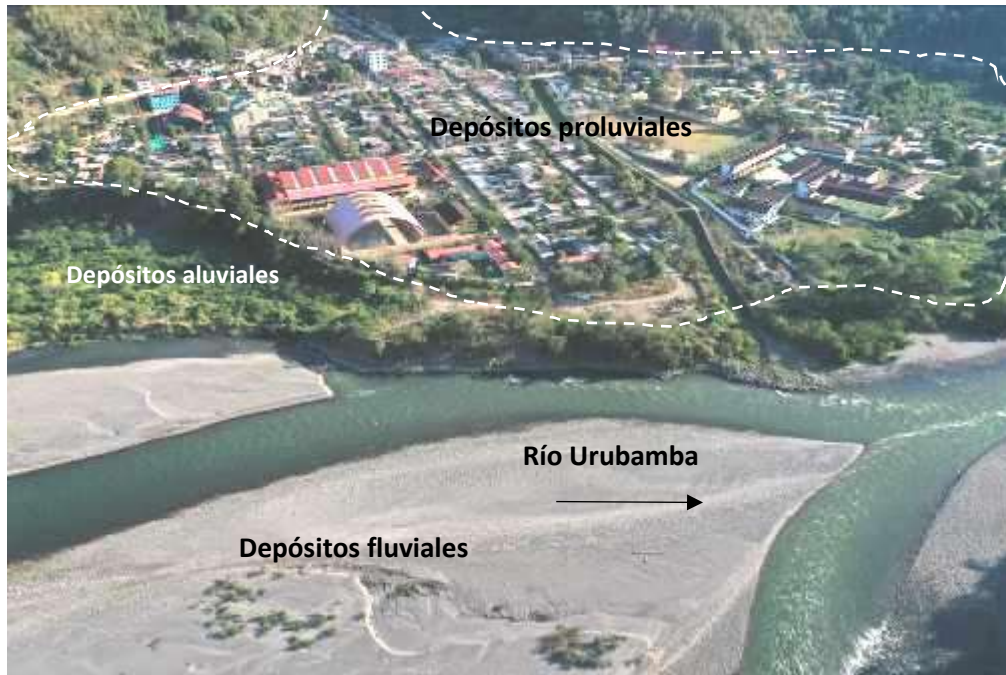
Fotografía 7. Vista aérea de depósitos proluviales, aluviales y fluviales en el centro poblado de Palma Real
