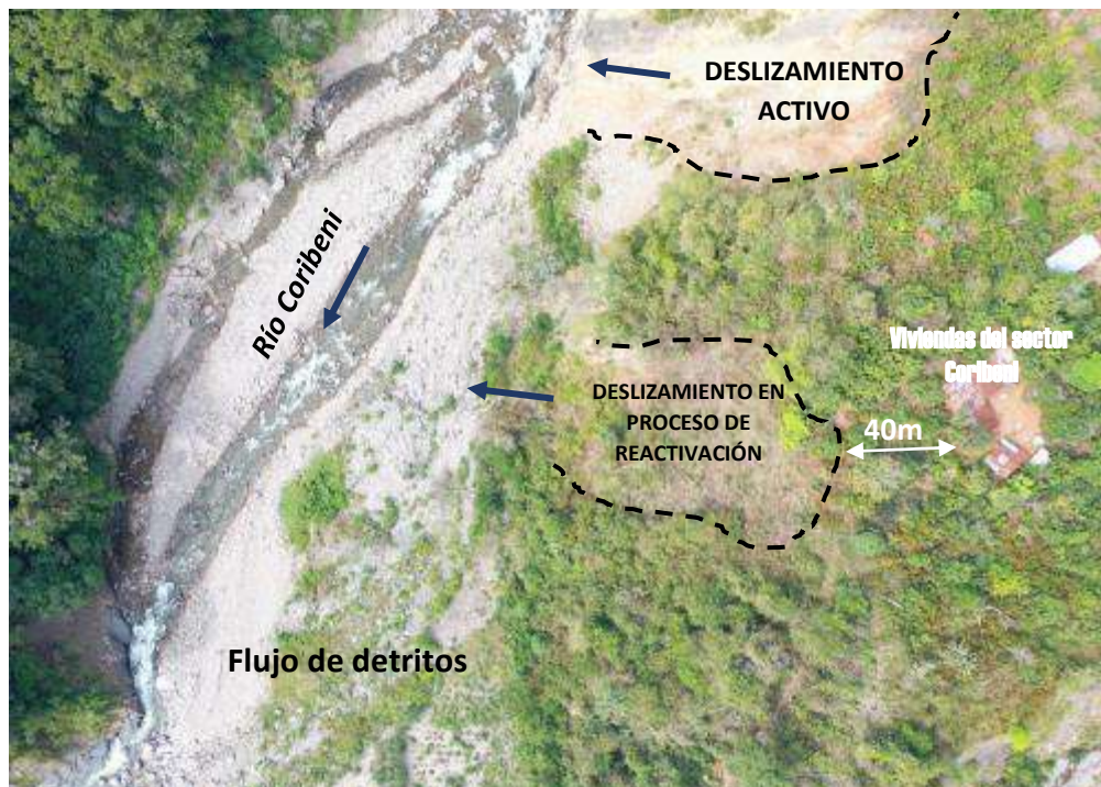
Fotografía 20. Deslizamiento en proceso de reactivación a 40 m de viviendas del sector Coribeni.
