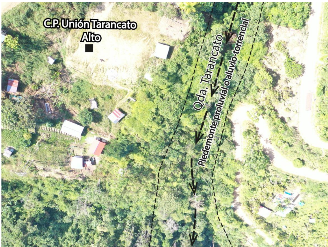
Fotografía 4: Vista aérea de la geofoma piedemonte proluvial o aluvio-torrencial a lo largo de la quebrada Tarancato
