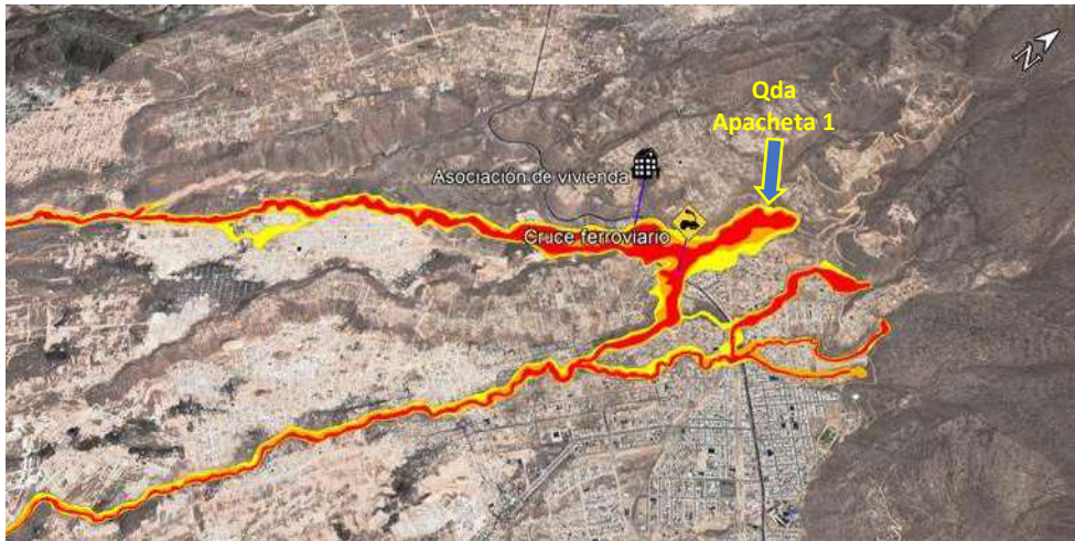
Figura 55. Simulación de lahares en la quebrada Apacheta 1
