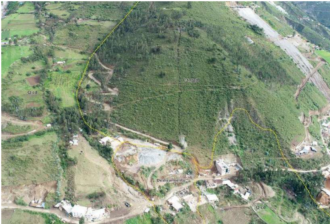
Figura 2. Macizo compuesto por tonalitas, granodioritas (C-tn/gr) y los depósitos coluviodeluviales en la zona del centro poblado de Carhuabamba.
