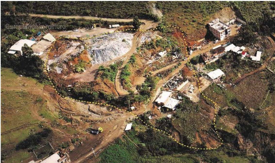
Figura 7. Delimitada con línea amarilla se observa la vista de perfil del deslizamiento en el centro poblado Carhuabamba. Coordenadas UTM: 215511.00 / 9141315.98, Zona 18.
