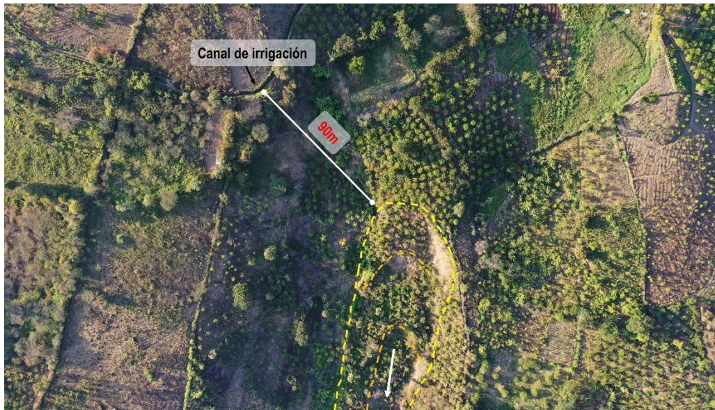
Figura 11. Vista de la parte alta del cuerpo del deslizamiento (en línea amarilla) donde se aprecia la cercanía a un canal de irrigación y algunos escarpes secundarios (en línea naranjada).
