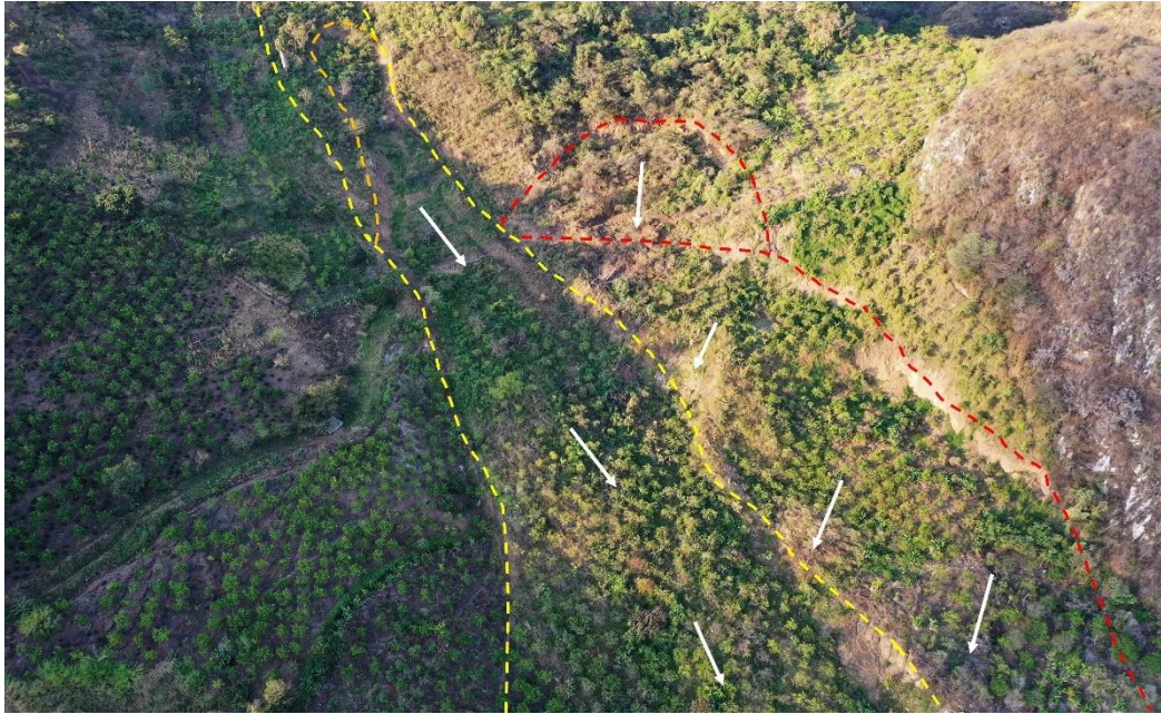
Figura 12. Vista del cuerpo central del deslizamiento (en línea amarilla), donde se aprecian los dos deslizamientos contiguos (en línea roja) y otro escarpe secundario (en línea naranjada).
