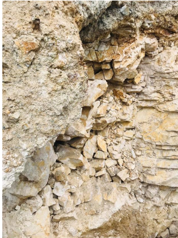
Fotografía 2. Aforamientos de calizas muy fracturadas y altamente meteorizadas en la margen izquierda de la carretera Andahuaylas a José María Arguedas. Cerro Apu Huayhuaca.
