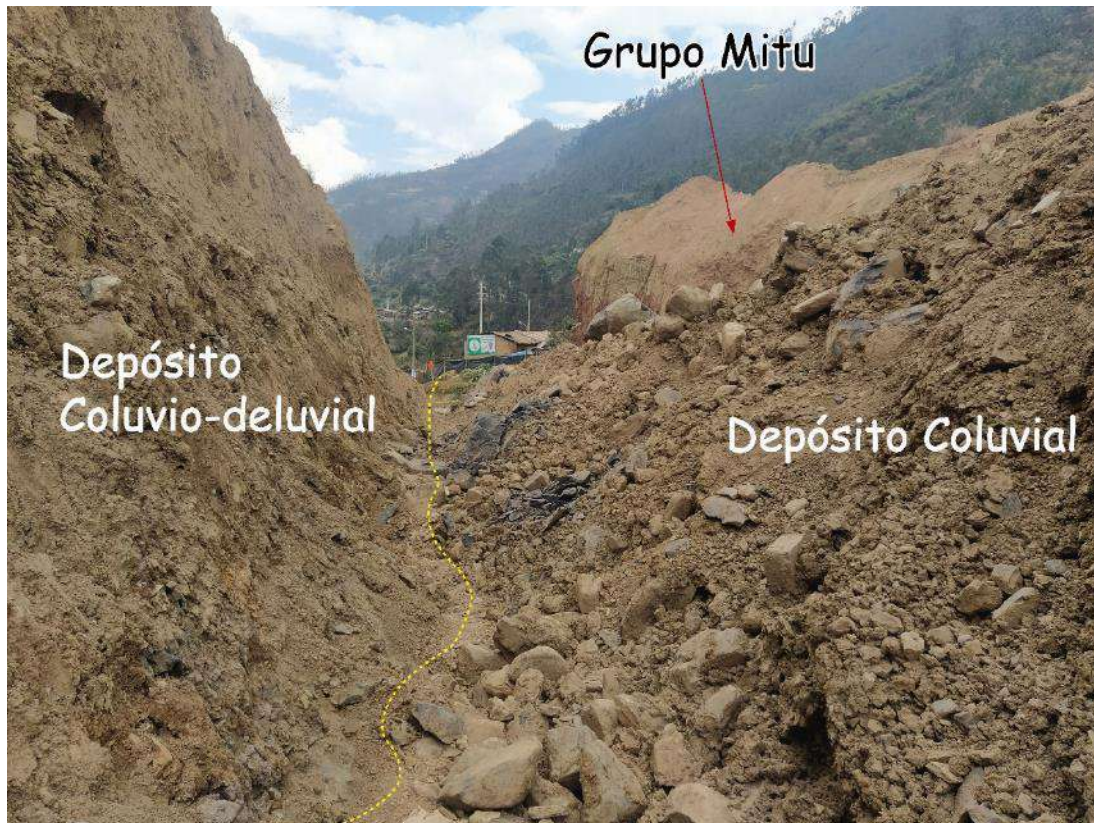
Figura 15. Obsérvese la diferencia en el grado de consolidación entre los depósitos coluvio-deluviales (poco consolidado) y coluviales (suelos).
