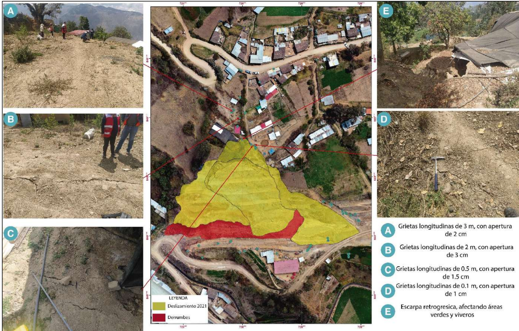
Figura 33. Ubicación de agrietamientos a 25 m de la escarpa principal del deslizamiento de Umaccata.
