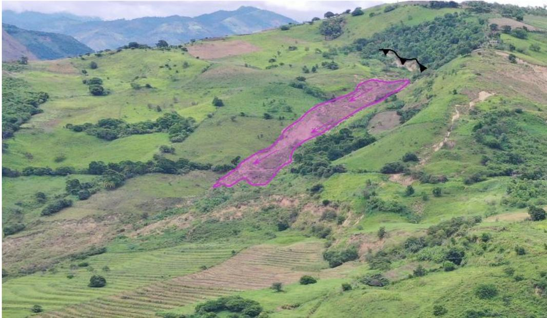
**Figura 10.** Flujo no canalizado ubicado al noroeste del deslizamiento.
