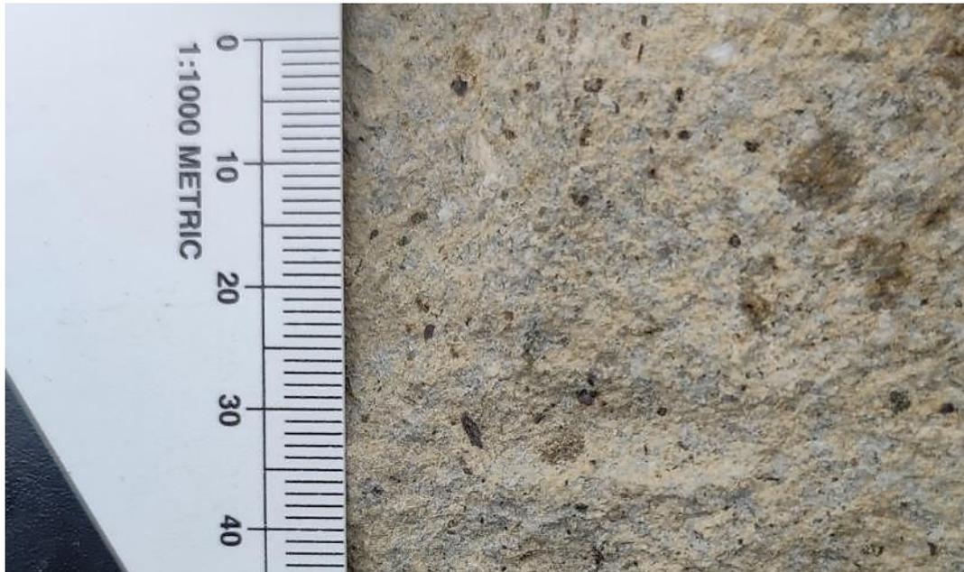
**Fotografía 1.** Muestra de mano de la unidad Centro Volcánico Tantahuatay compuesta por cristales alterados de plageoclasas y cuarzos; además de ferromagnesianos (biotitas y hornblendas).
