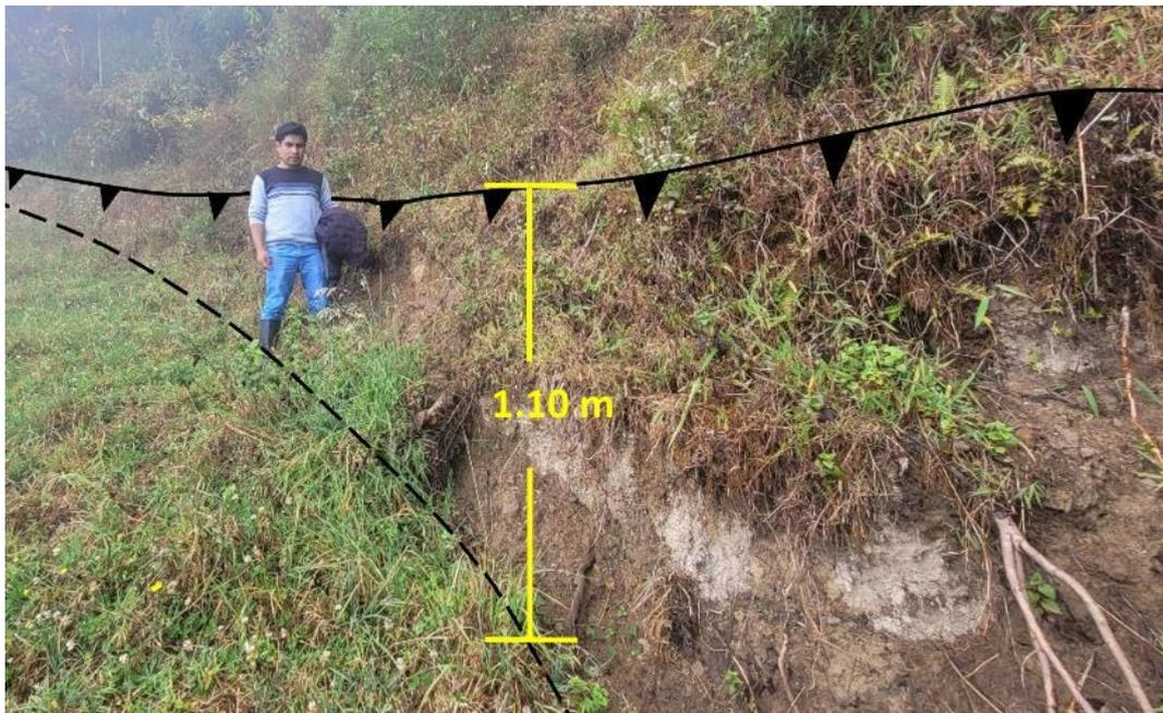
**Figura 12.** Salto de escarpe principal. (Coordenadas UTM WS-84 -17S, Norte: 9261468 – Este: 751753).
