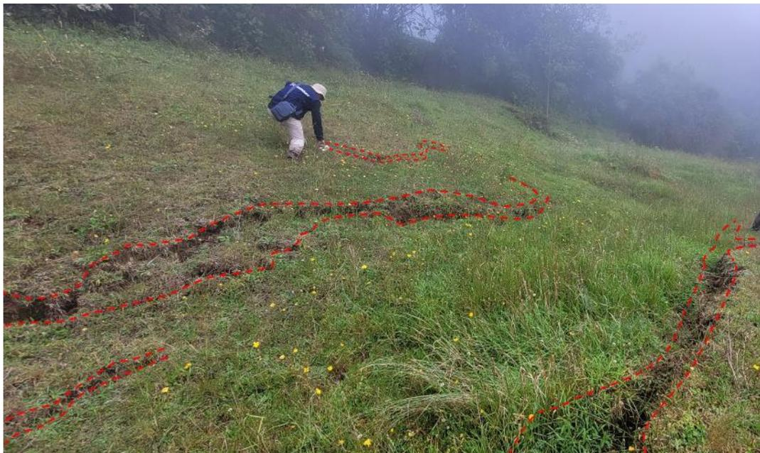
**Figura 14.** Agrietamientos en terrenos ocupados por pastos naturales, con longitudes de 4 a 15 m y ancho de 5 a 20 cm, con desplazamiento vertical de 5 a 10 cm. (Coordenadas UTM WS-84 -17S, **Norte:** 9261790– **Este:** 752075).
