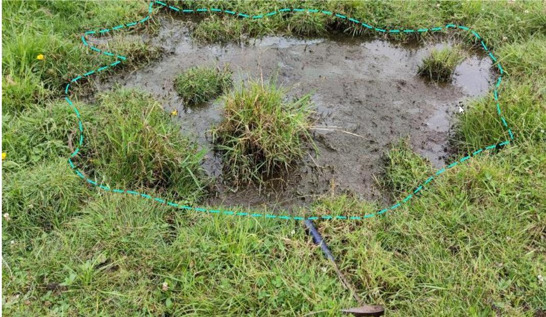
**Figura 15.** Surgencia de agua, nos indica que los terrenos se encuentran saturados.
