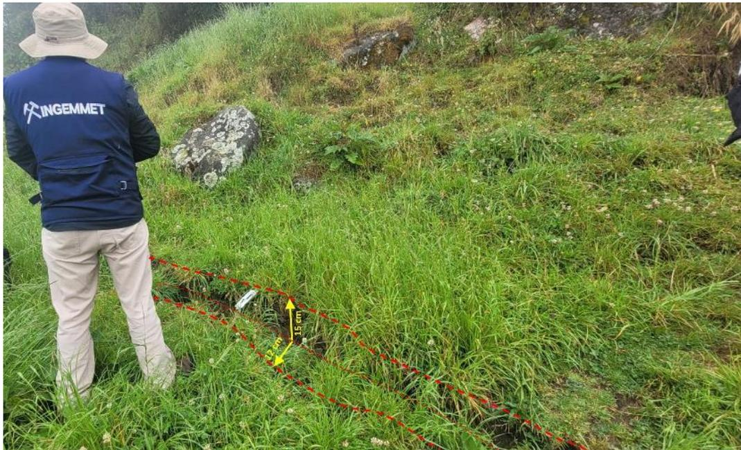
**Figura 13.** Agrietamientos sobre el cuerpo de deslizamiento con longitud de 45 m y 10 a 15 cm de ancho, con desplazamiento vertical de 15 cm. (Coordenadas UTM WS-84 -17S, **Norte:** 9261648 – **Este:** 751658).
