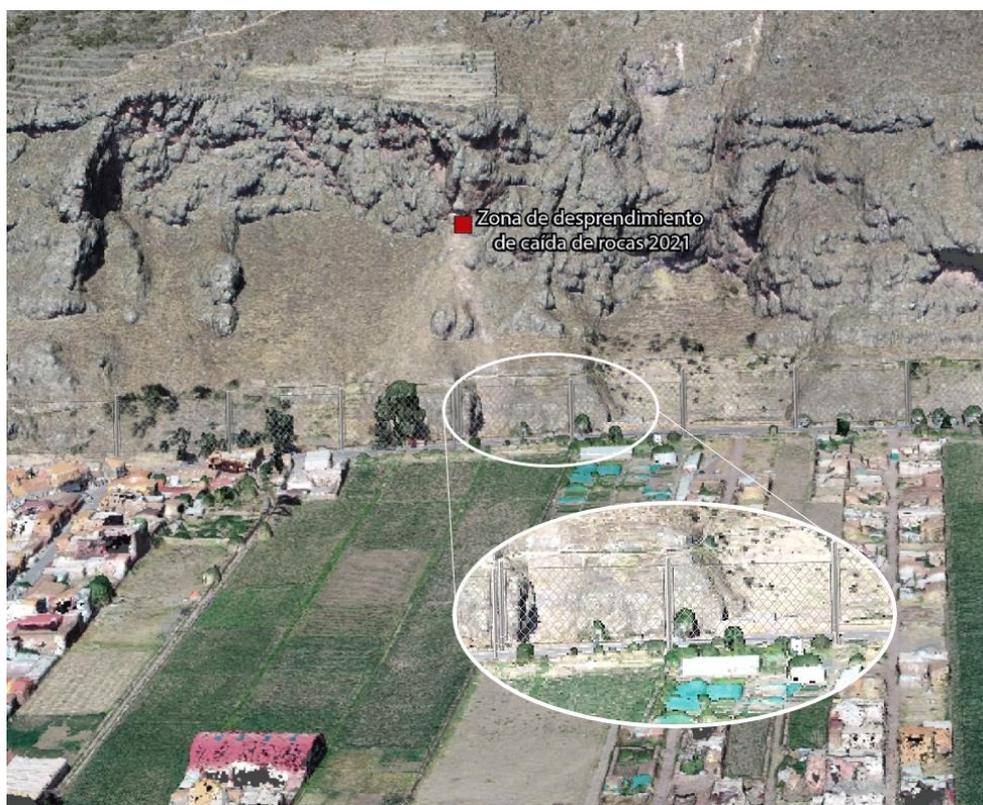
**Figura 30.** Vista de barreras al pie del talud de la ladera
