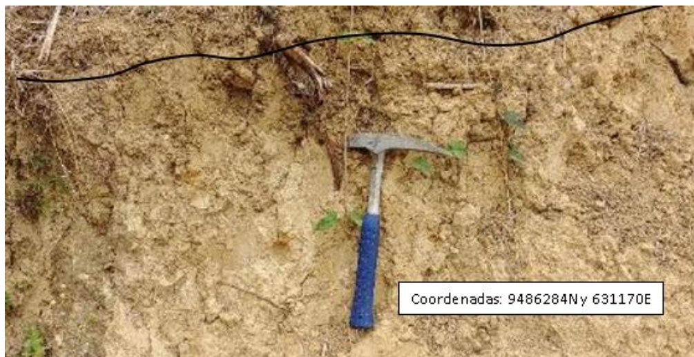
Figura 24. Margas muy meteorizadas, mediante prueba de martillo se fracturan con facilidad, en el sector Loma de Siccate.
