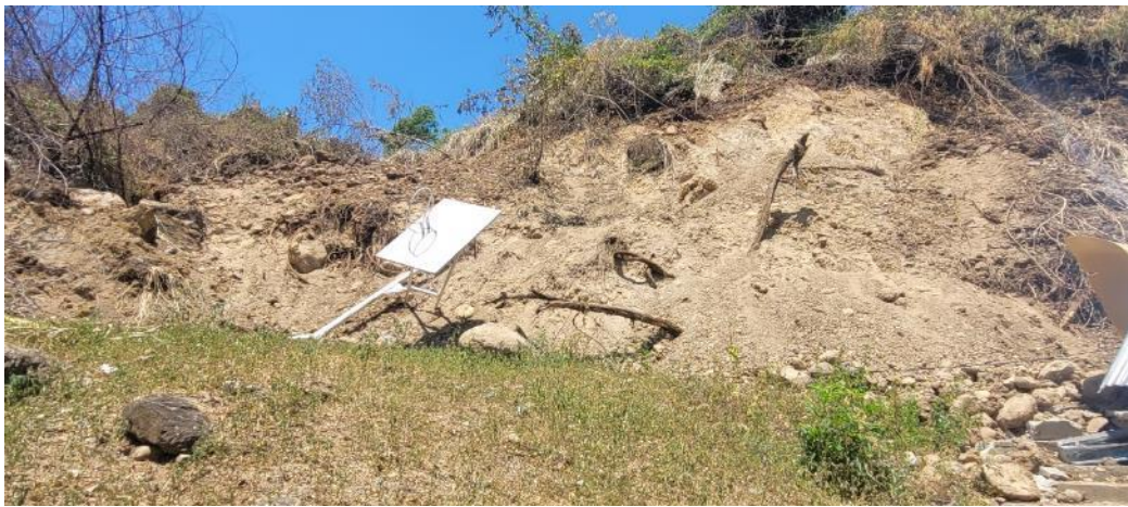
Fotografía 2. Vista de los suelos coluvio-deluviales depositados en la parte baja del deslizamiento Cunía. Ubicación: E: 740157; N: 9404132; Z: 630.
