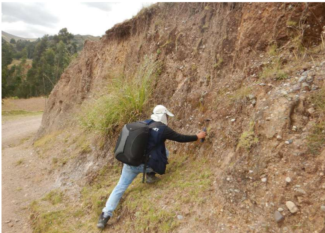
Fotografía 1. Depósito coluvio-deluvial compuesto por fragmentos de rocas volcánicas subangulosos a subredondeados, heterométricos y envueltos en una matriz de arenas, limos y arcillas, ubicado en el caserío de Ututupampa.
