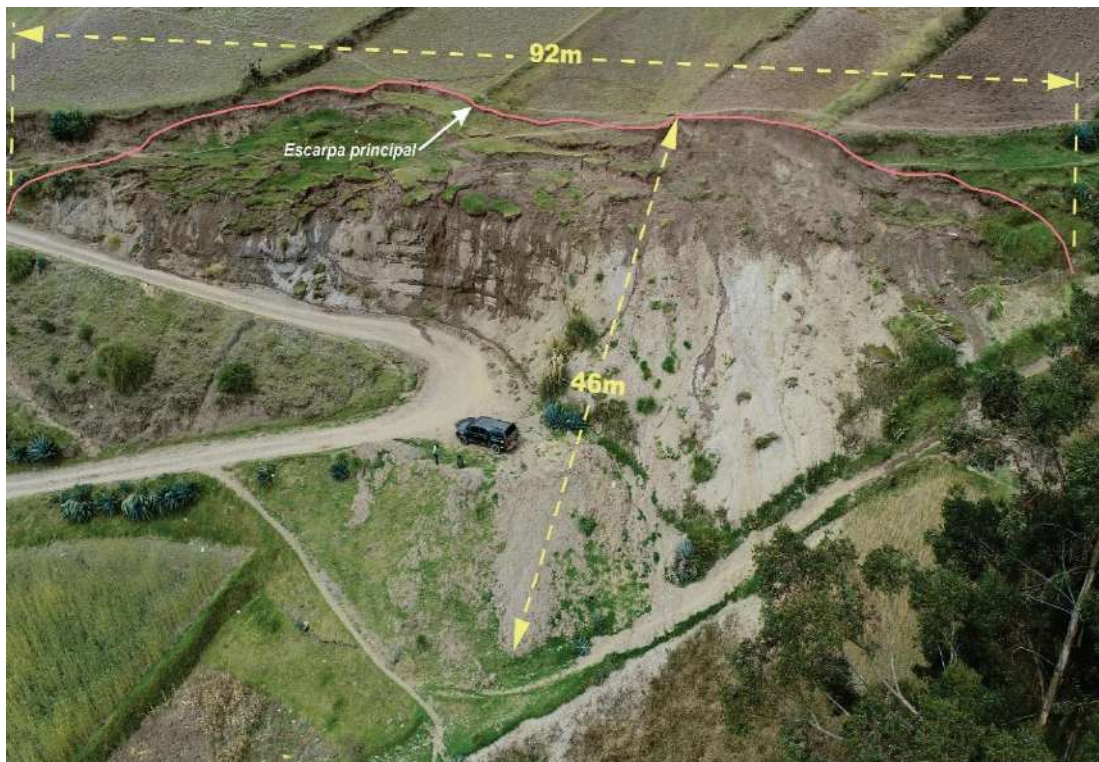
Figura 14. Dimensiones del deslizamiento rotacional del caserío Ututupampa, presenta una longitud de la escarpa de 92 m y desnivel entre la escarpa y el pie de 46 m; se pudo evidenciar la presencia de agua subterránea que emana por el cuerpo del evento.
