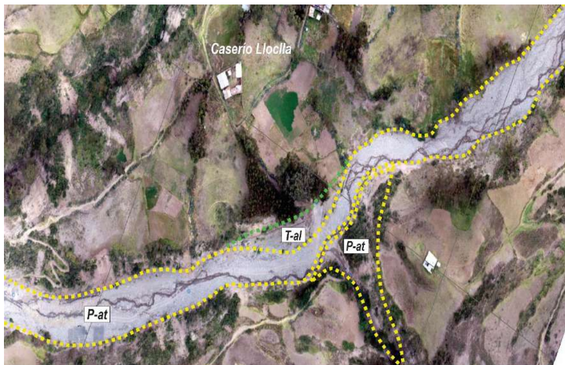
Figura 12. Vista de la subunidad de vertiente aluvio torrencial y terrazas aluvial con pendientes ligeramente inclinadas ( 1^\circ a 5^\circ ). A su flanco izquierdo se puede apreciar laderas de fuerte pendiente con depósitos coluviales producto de movimientos de ladera.
