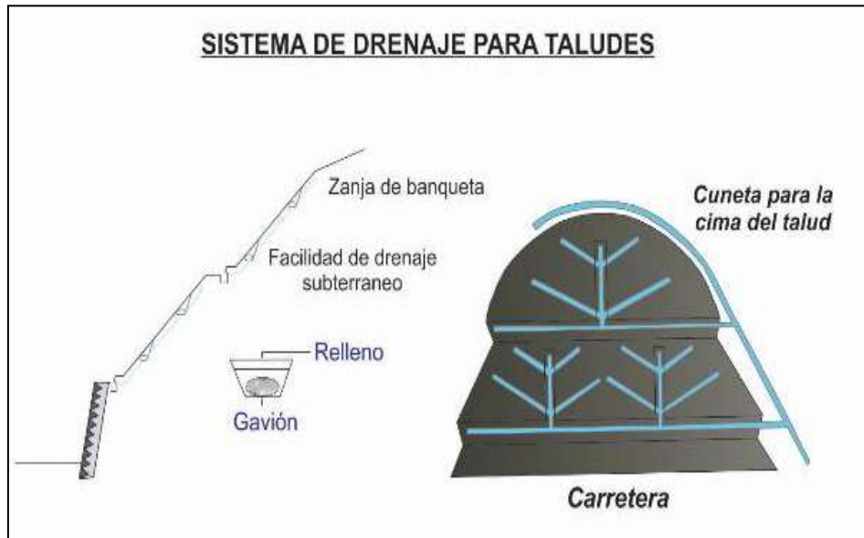
Figura 1. Drenaje tipo espina de pescado (Modificado, Sosa 2019)
