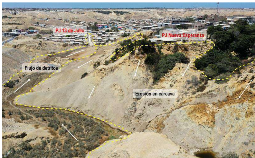
Figura 15. Vista de los sectores con erosión en cárcava del PJ Nueva Esperanza y el flujo de detritos que afecta al PJ 13 de Julio.
