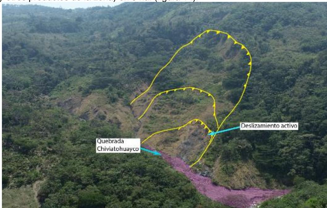
**Figura 14.** Vista del proceso de movimientos en masa de tipo deslizamiento rotacional (enmarcado en líneas amarillas) y flujos de detritos en el cauce de la quebrada (polígono de color morado)
