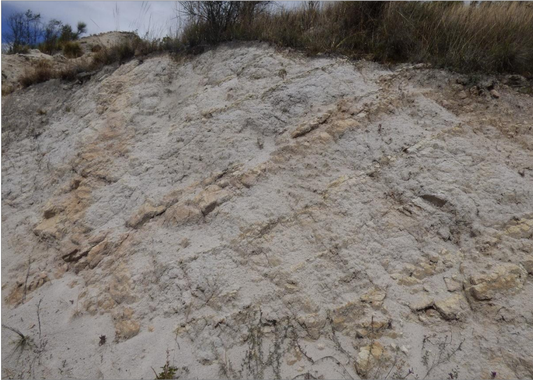
Fotografía 1. Afloramiento rocoso, conformado por arcillitas de color gris oscuro y areniscas limosas meteorizadas y fracturada en el techo.
