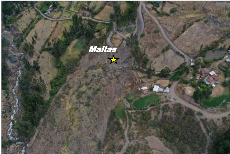
Figura 40. Vista de la reactivación del deslizamiento de Mallas, el cual afectó la trocha carrozable y viviendas asentadas en el cuerpo del evento.
