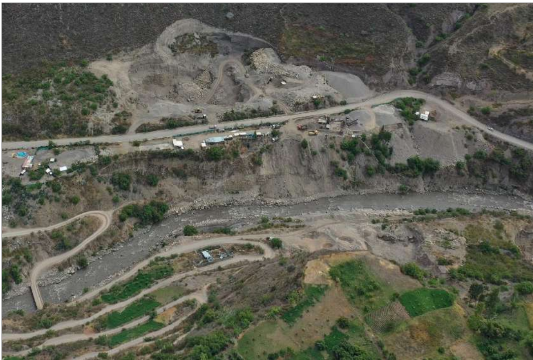
Fotografía 6. Depósito antropógenos (Q-an), originado por la acción del hombre mediante procesos de transformación industrial tipo canteras.
