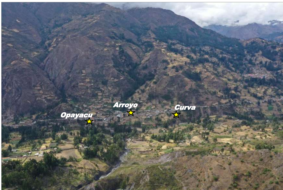
Figura 27. Vista al este de los sectores Curva, Arroyo y Opayacu; asentado sobre depósitos de eventos antiguos; los primeros se encuentran asentados sobre el cuerpo de un deslizamiento antiguo; mientras que el segundo se sitúa sobre una terraza aluvioproluvial, es decir acumulaciones de huaicos antiguos.
