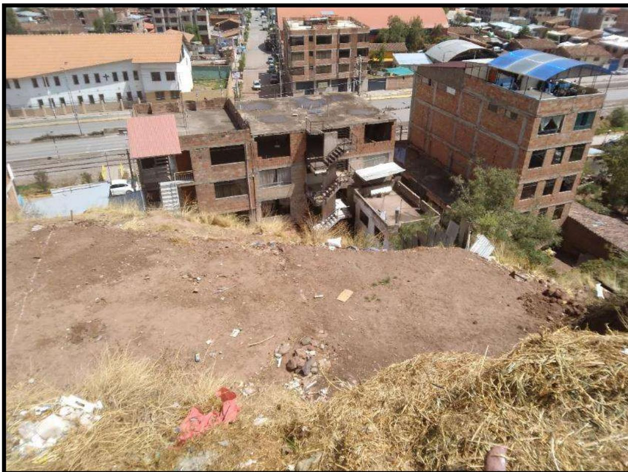
*En la imagen se puede observar que en una parte del talud está siendo cortado y rellenado para ser lotizado pudiendo originar desastres en la zona por la desestabilización que se generaría en el suelo.*
