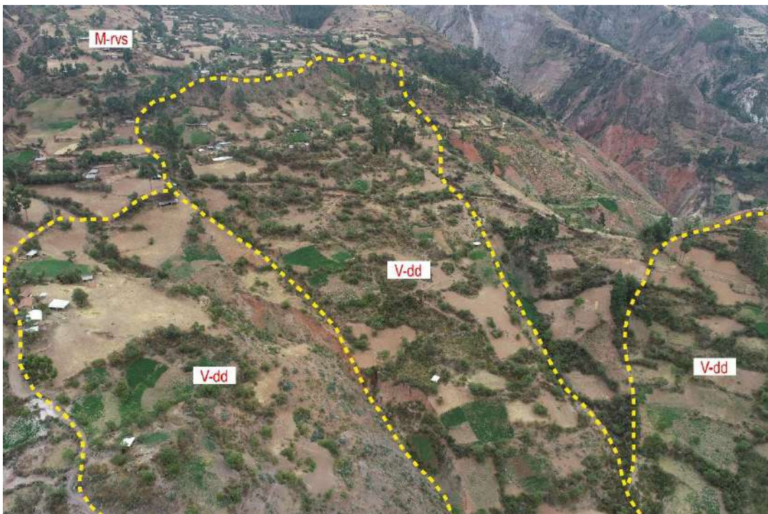
Figura 11. Vista de la subunidad de vertiente con depósito de deslizamiento (V-dd) ubicado en la comunidad de Cedro (al norte de la zona de estudio), originado por procesos de movimientos en masa antiguos.
