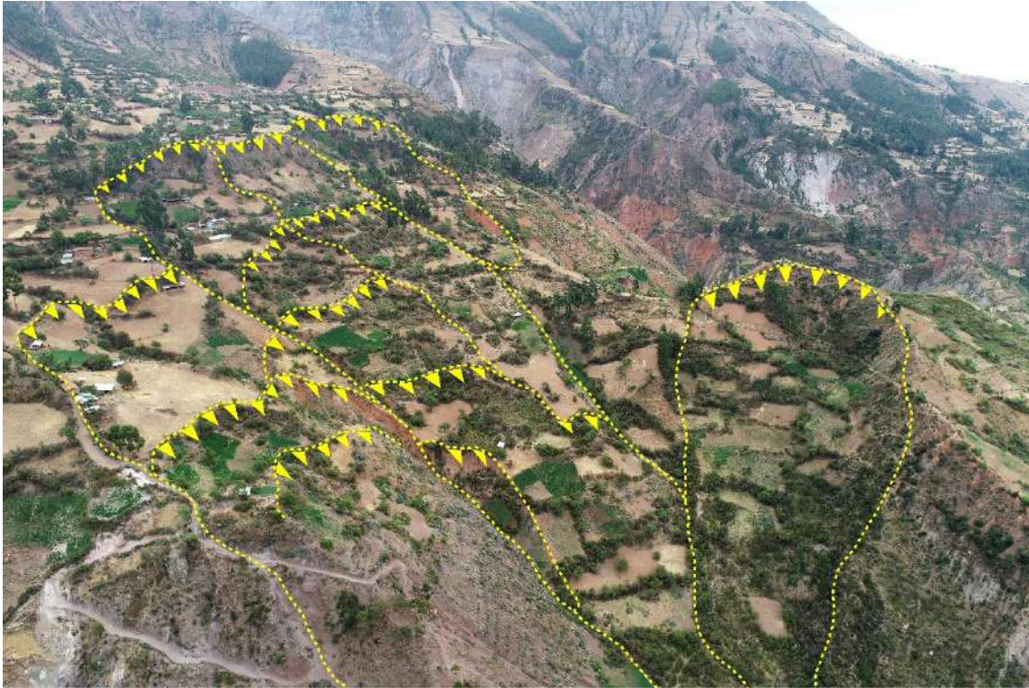
Figura 12. Vista de diferentes deslizamientos rotacionales antiguos, con múltiples escarpas que manifiestan reactivaciones antiguas del evento dispuestos al pie de la ladera y cuya masa desplazada presenta una dirección preferente al este-sureste, hacia el río Tomarenga.
