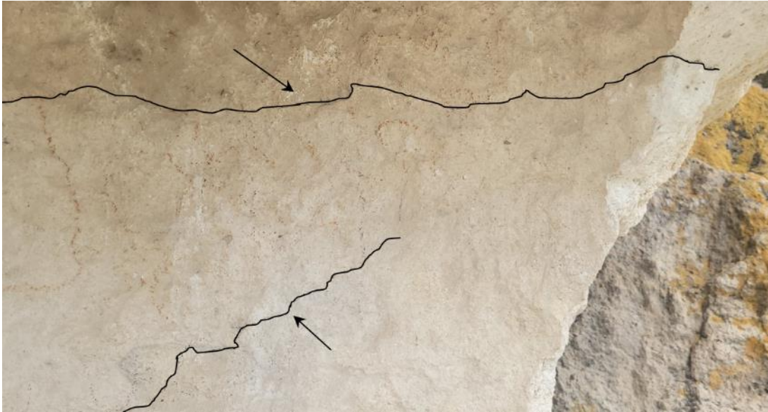
Figura 21. Macizo altamente meteorizado, con presencia de diaclasas (líneas negras).
