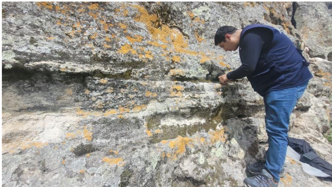
Fotografía 1. Descripción con rumbo y buzamiento.
