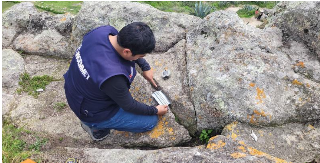
Fotografía 4. Medición de la rugosidad mediante el peine de Barton.
