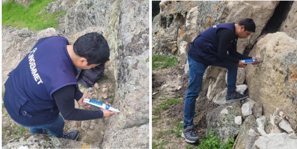
Fotografía 3. Medición de la resistencia de la cara de las discontinuidades de los macizos del sitio arqueológico Ventanillas de Otuzco mediante la aplicación del martillo Schmidt; estación 1 (izquierda) y estación 2 (derecha).
