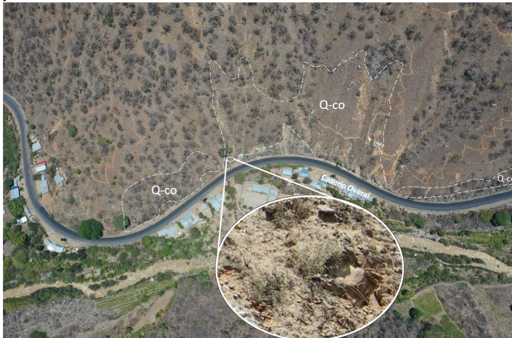
Figura 2. Se observa un depósito coluvio – deluvial, compuesto por bloques y gravas sub angulosas, en matriz limo arcillosa.
