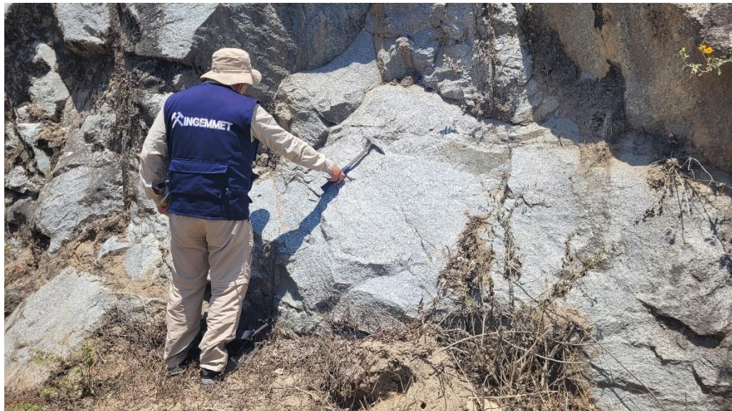
Fotografía 3. Se observa el intrusivo tonalítico – granodiorítico, poco a medianamente fracturado y ligeramente meteorizado.
