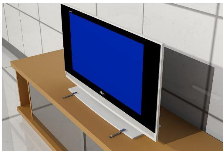
Figura 88. Formas de asegurar equipos electrónicos, mediante seguros de correas
