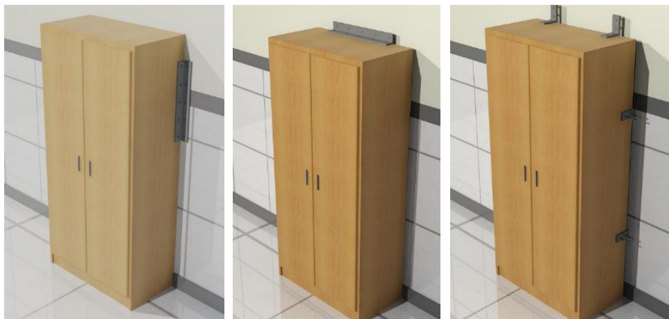
Figura 86. Muebles y armarios deben estar fijados y asegurados afín de evitar caídas que afecten al personal de salud o que obstruyan salidas o corredores de evacuación.
