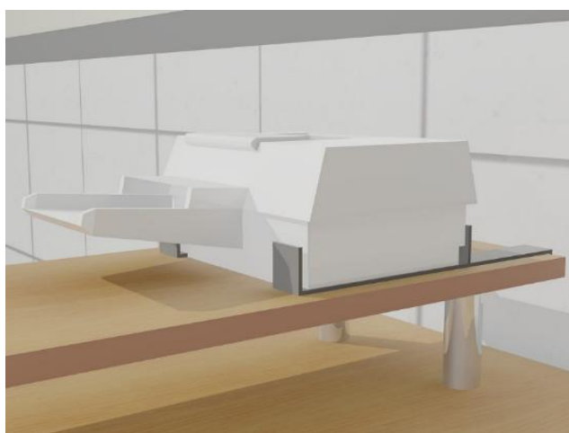
Figura 84. Equipos como impresoras deben estar sujetos a asegurados para evitar su desplazamiento ante movimientos sísmicos.
