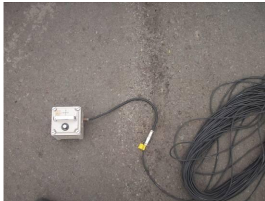
Figura AI-1. Equipo de adquisición de datos GEODAS 15 HS (izq.) y sensor de 1 HZ de frecuencia tipo CR4.5-1S (der).
