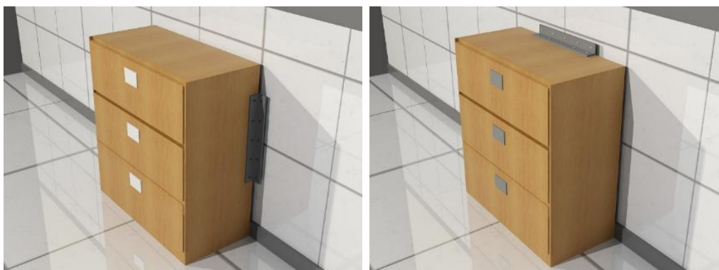
Figura 85. Archiveros deben estar asegurados y evitar caídas que obstruyan salidas o corredores de evacuación. .
