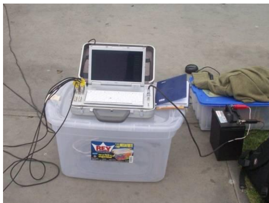
Figura AI-1. Equipo de adquisición de datos GEODAS 15 HS (izq.) y sensor de 1 HZ de frecuencia tipo CR4.5-1S (der).
