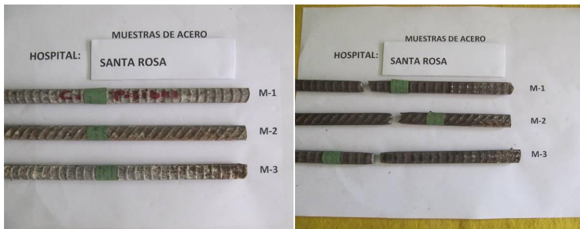
Foto 26. Muestras de acero, antes y después del ensayo de tracción
