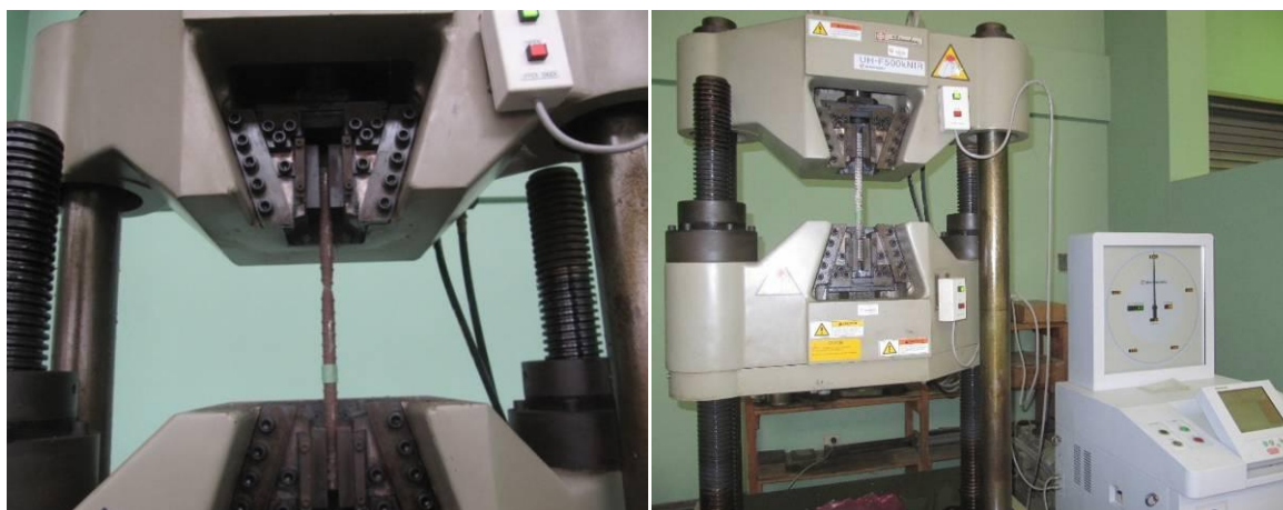
Foto 27. Ensayo de tracción de muestras de acero
