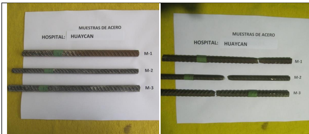
Foto EE3. Muestras de acero, antes y después del ensayo de tracción
