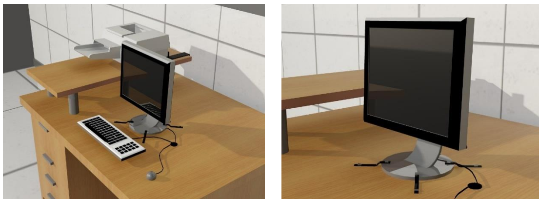
Figura 14. Monitor fijado con correas al mueble de escritorio y evitar su caídas ante movimientos sísmicos
