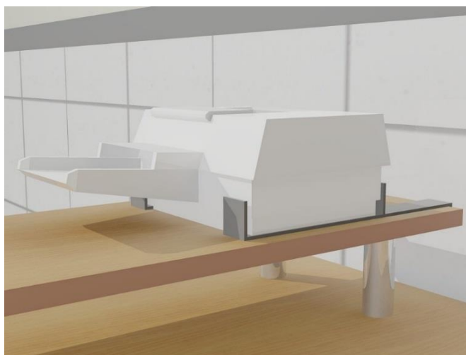
Figura 15. Equipos como impresoras deben estar sujetos a asegurados para evitar su desplazamiento ante
