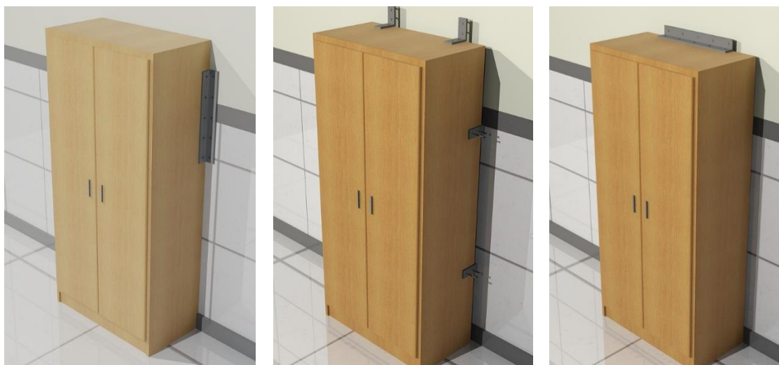
Figura 17. Muebles y armarios deben estar fijados y asegurados afín de evitar caídas que afecten al personal de salud o que obstruyan salidas o corredores de evacuación
