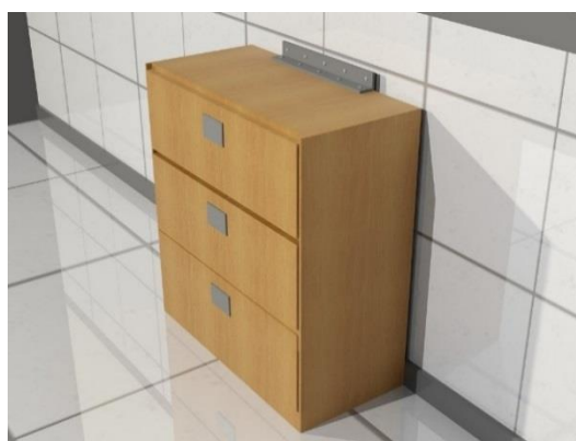
Figura 16. Archiveros deben estar asegurados y evitar caídas que obstruyan salidas o corredores de evacuación. .
