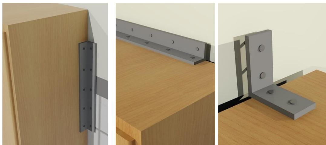
Figura 18. Los sistemas de aseguración pueden ser de diferentes tipos, en las zonas laterales o partes superiores, el objetivo es contar con puntos de sujeción ante volcamientos o caídas
