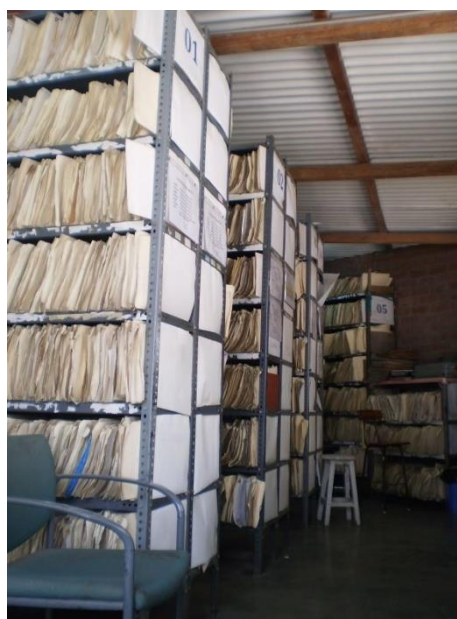
Foto 56. Estanterías no fijadas a la pared, piso o techo, que tienden al volcamiento en casos eventuales. Otro factor, es el desplazamiento de los contenidos que no se encuentran asegurados.
