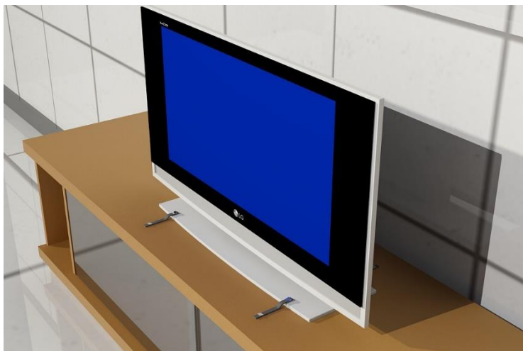
Figura 19. Formas de asegurar equipos electrónicos, mediante seguros de correas
