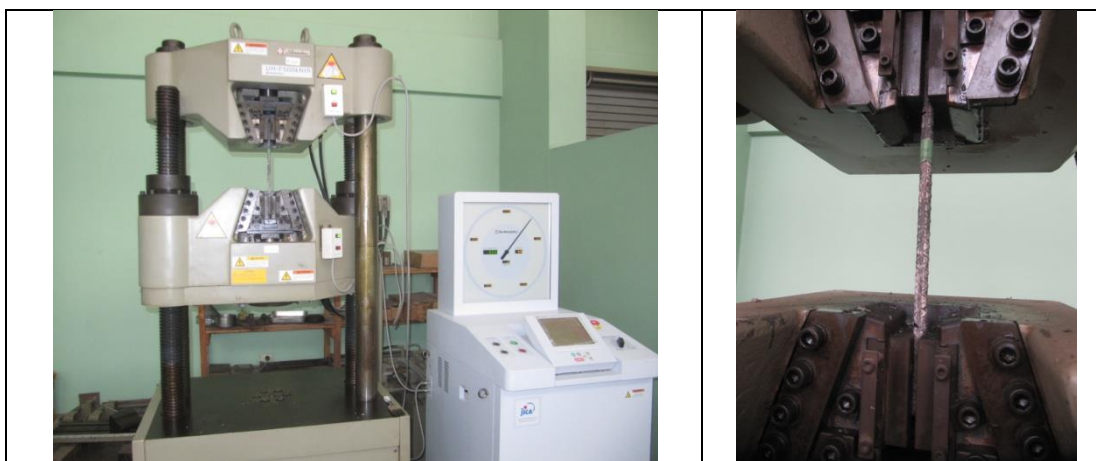
Foto EE4. Ensayo de tracción de muestras de acero
