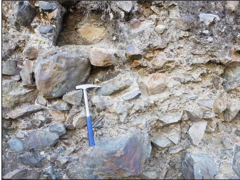
**Fotografía 4.** Estructura interna de una morrena (Cordillera Blanca). Se observa que el Till, no tiene una clasificación definida y los bloques rocosos y detritos son heterogéneos.
