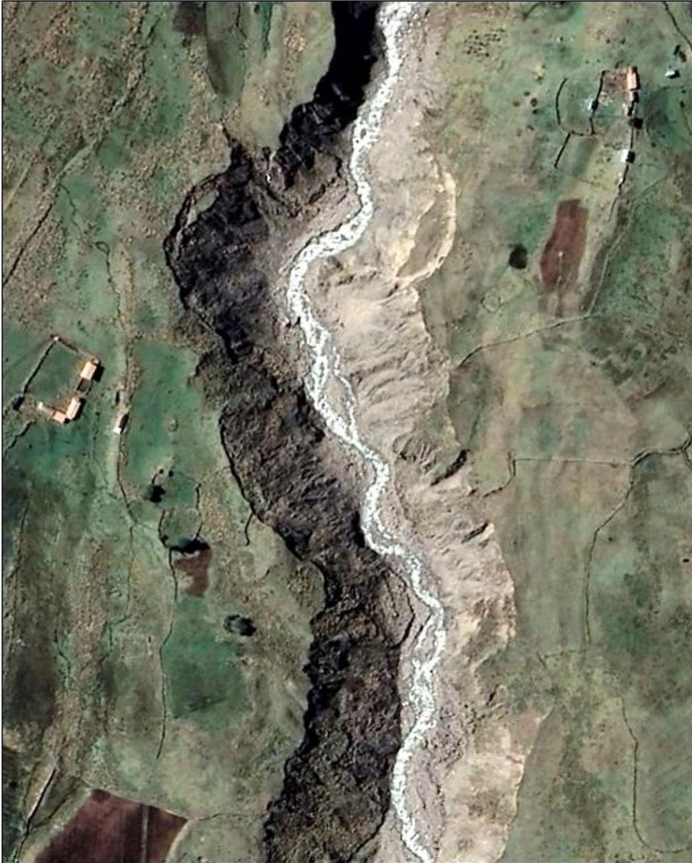
*Figura 26. Intenso socavamiento basal y lateral en la parte media del valle Upis, que activa deslizamientos y derrumbes.*
