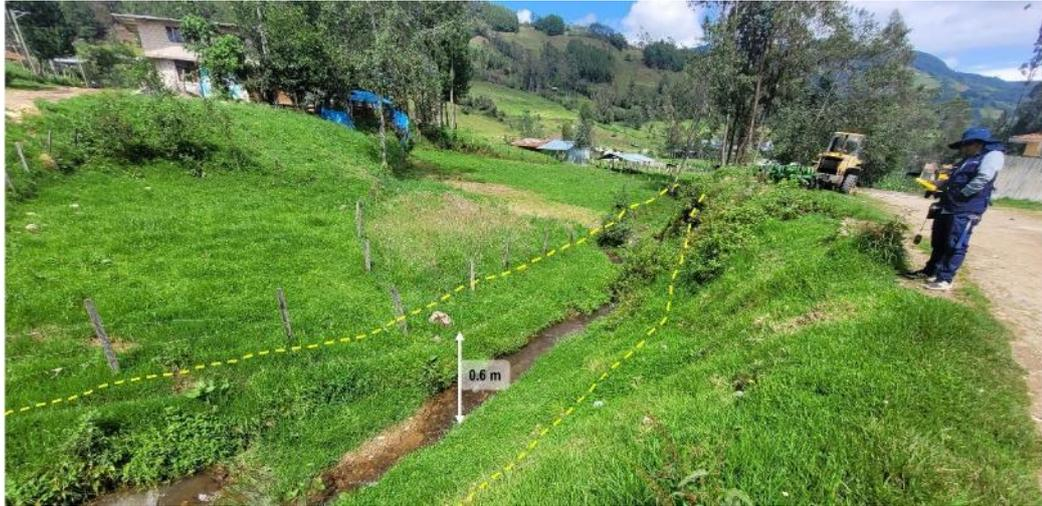
**Figura 9.** Parte alta de la quebrada Quitahuasi, probable altura de inundación de 0.6 m.
