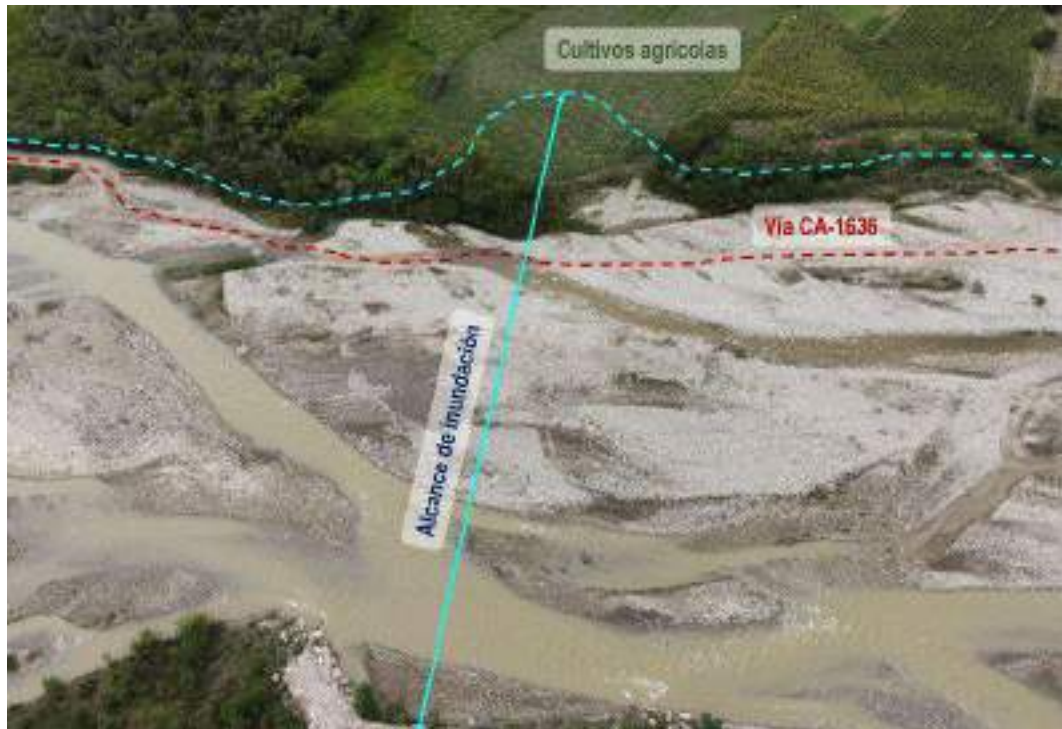
Figura 12. Lugar del perfil A-A', donde se aprecia a la vía vecinal CA-1636 y cultivos susceptibles a inundación fluvial. Ubicación: E: 811130, N: 9166622.
