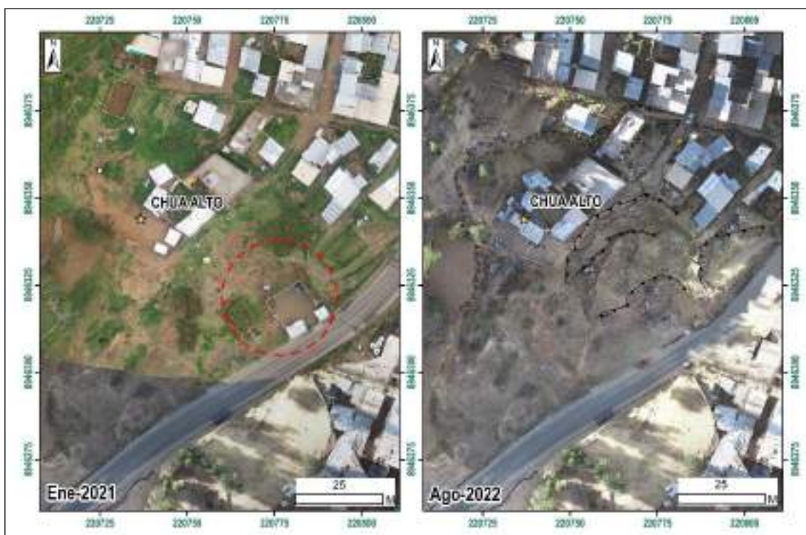
Figura 7: Comparación de imágenes antes del evento (enero 2021) y posterior deslizamiento (agosto, 2022) estimándose un área de afectación de 0.19 ha. Así mismo se puede observar los cortes de talud que se realizaban para la construcción de nuevas viviendas.
