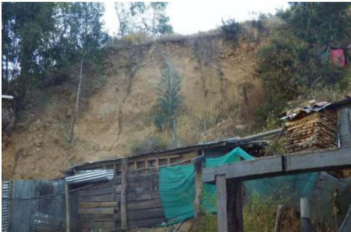
Fotografía 1: Vista del depósito coluvio-deluvial poco consolidado, compuestos por fragmentos de roca angulosos a subangulosos de tamaños variables (0.05 a 0.20 m), envueltos en una matriz limo-arcilloso.
