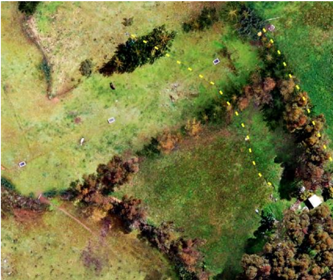
Figura 14. Imagen del dron (marzo 2023), se muestra los agrietamientos del terreno (Línea amarilla).
