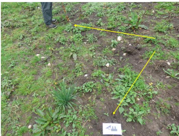
Fotografía 12. Muestra el escarpe que se inició el 2020, actualmente tiene una altura mayor de 1m con desplazamiento horizontal hasta de 40 cm.
