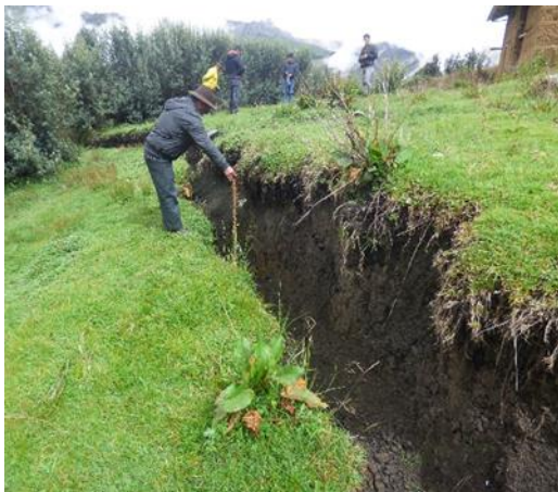
Fotografía 12. Muestra el escarpe que se inició el 2020, actualmente tiene una altura mayor de 1m con desplazamiento horizontal hasta de 40 cm.
