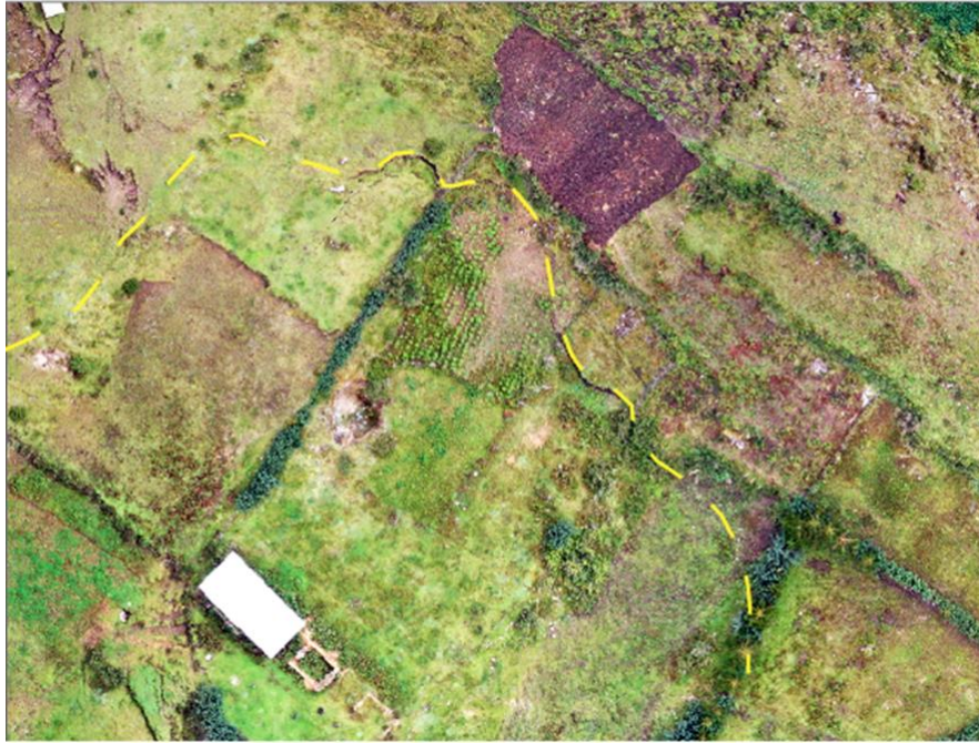
Figura 17. Parte superior del deslizamiento antiguo, se traza con línea amarilla puntuada la posible zona de falla, se está enmarcando un deslizamiento
