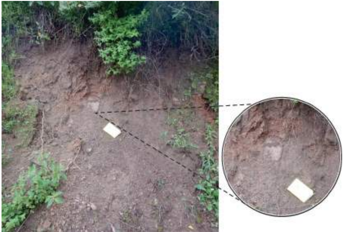
Figura 8. Depósito compuesto por fragmentos de rocas volcánicas subangulosos a subredondeados, heterométricos y envueltos en una matriz de arcillas, limos y arenas, ubicado la parte alta del centro poblado La Perla.
