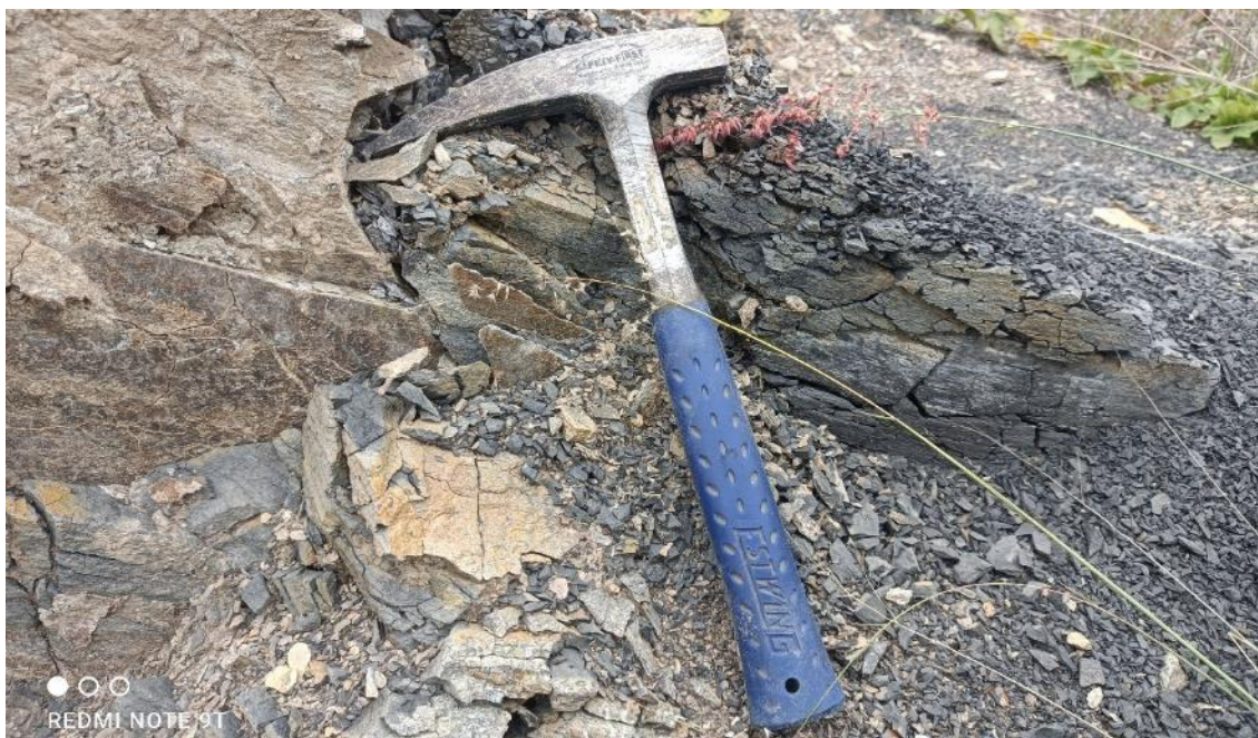
Fotografía 1. Se observa el macizo rocoso, muy fracturado y altamente meteorizado. Coordenada UTM WGS-84, 17S: E: 686485; N: 9374047.
