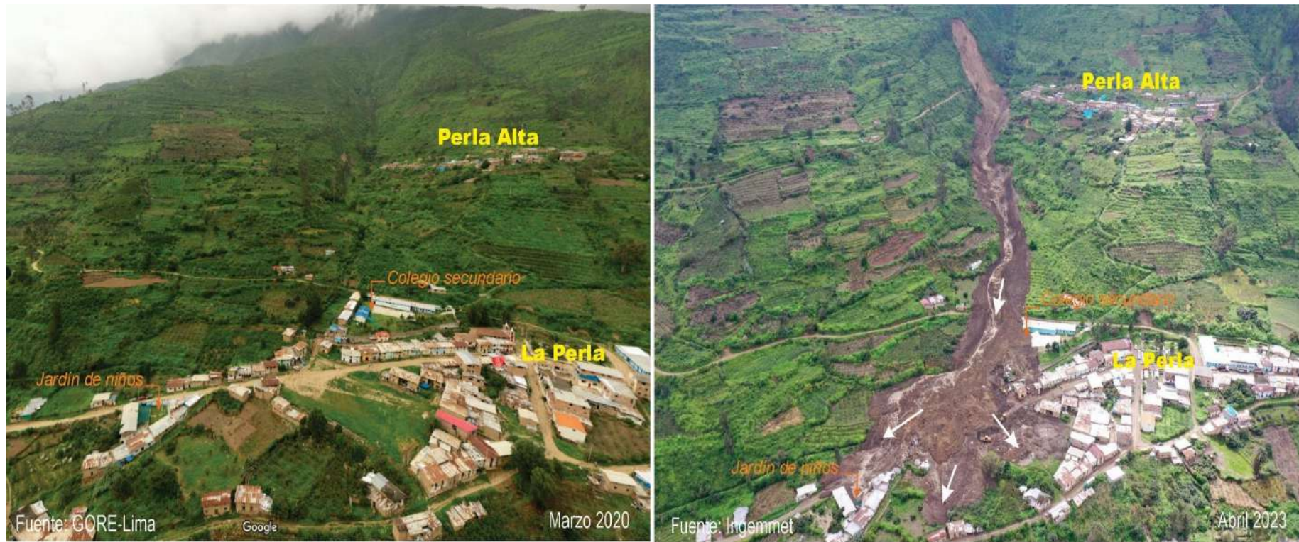
Figura 19. Comparación de una imagen obtenida del Google Earth del año 2020 y la fotografía tomada con dron (2023). En la primera se observa viviendas asentadas varias en el cauce de la quebrada. La segunda corresponde a la tomada post evento, se observa la avalancha de detritos, el cual afectó severamente viviendas, tramos de carretera, así como terrenos de cultivos.
