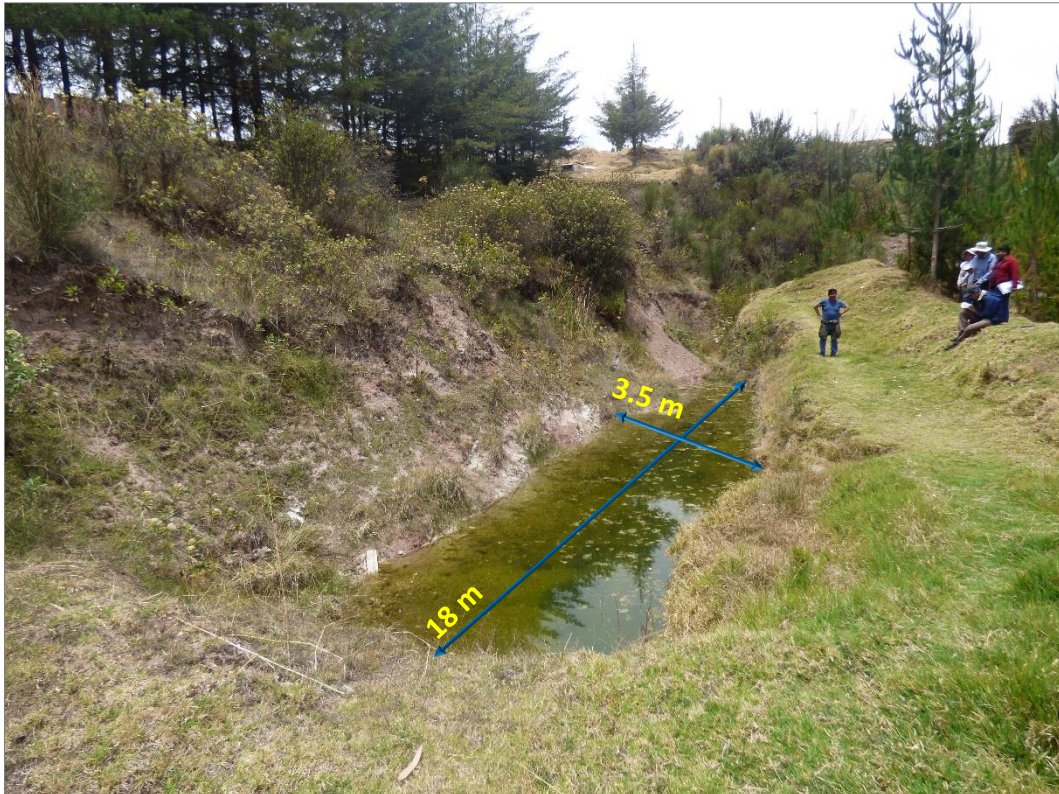
Figura 10. Vista de manantial, ubicado en la zona posterior a la corona, con un ancho aproximado de 3.5 m y una longitud de 18 m.
